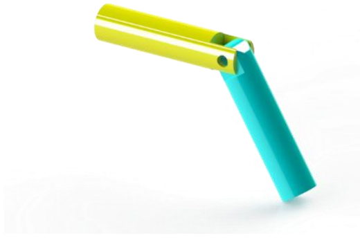
Şekil 2.5: Dönel eklem yapısı.
