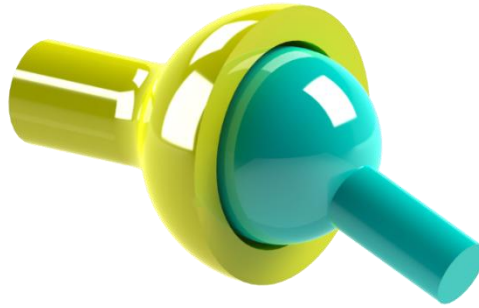
Şekil 2.10: Küresel eklem yapısı.
