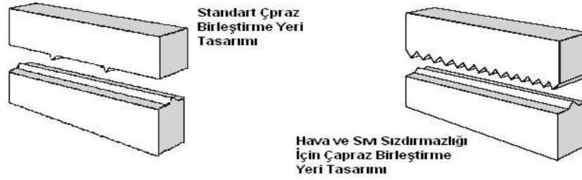
Şekil 7.5 Çapraz Enerji Yönlendiricili Birleşme Tasarımı
