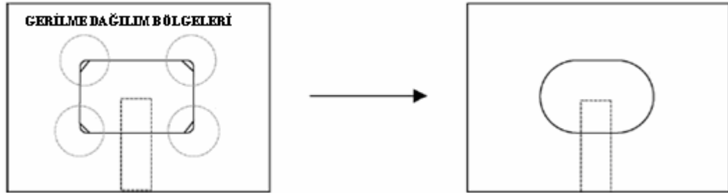
Şekil 3.3 Piston kesitinin değişimi [8]
