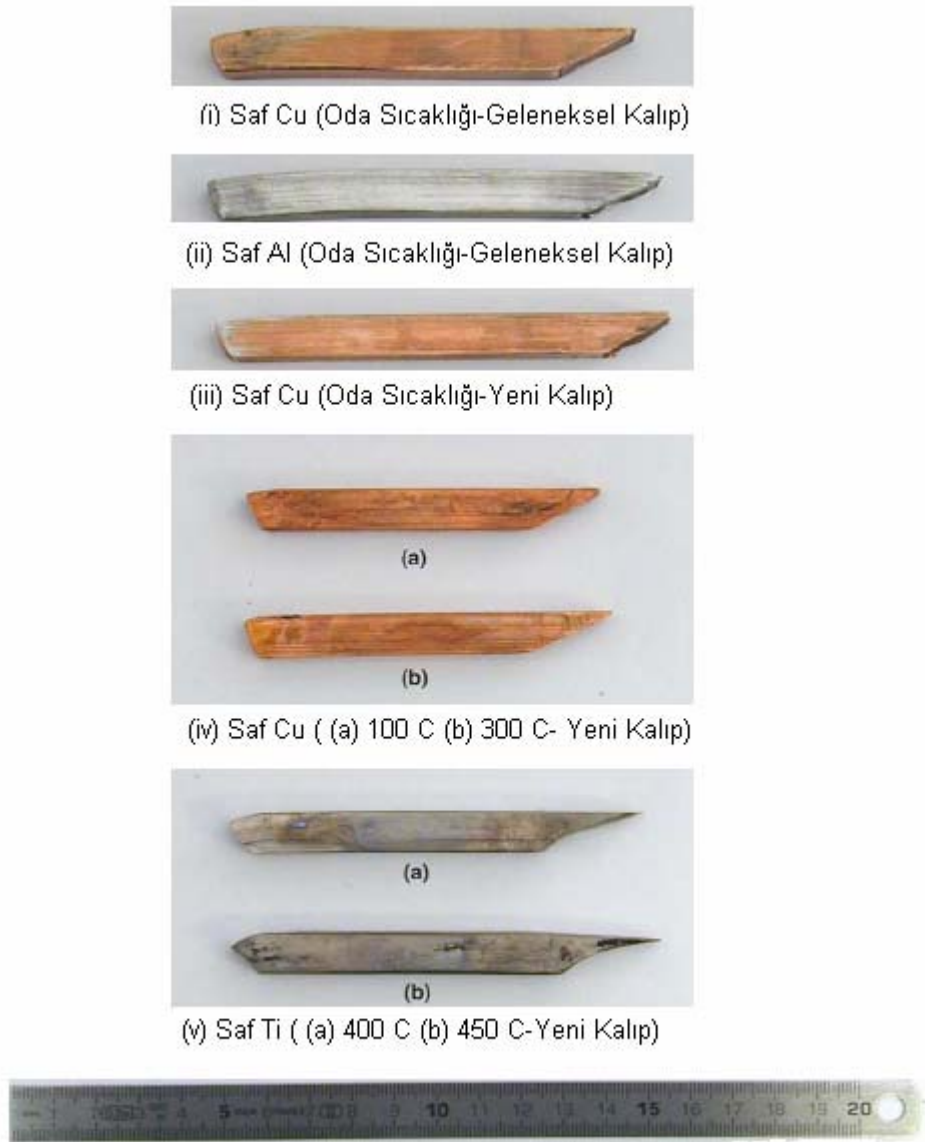
Şekil 3.6 Geleneksel ve yeni kalıpla ekaplanan farklı malzemeler [8]
