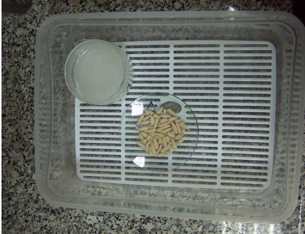
Foto 5.7: Yıkanarak saflaştırılmış bentonitin rutubet kontrol deneyi.
