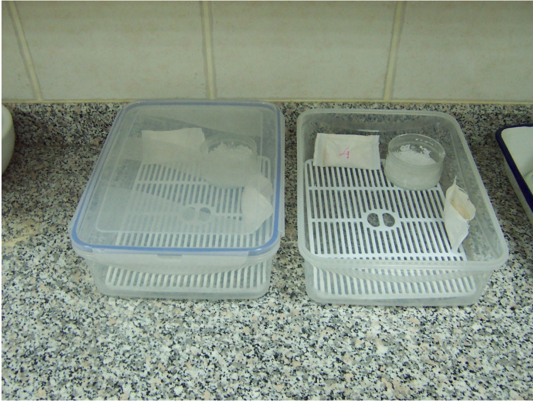
Foto 5.8: Bentonitin rutubet kontrol deneyi.
