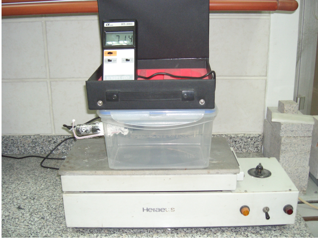
Foto 5.6: Rutubet ölçer ve içerisindeki havanın rutubeti ölçülen hücre.
