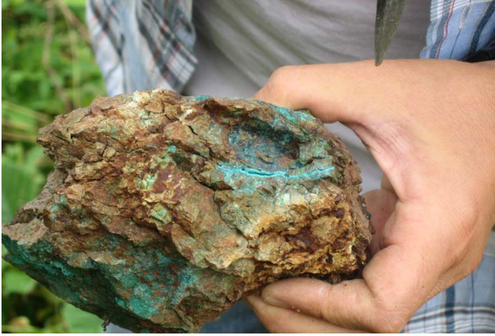
Şekil 2.17 c: Çatlaklarda bakışimli olarak gelişen globüler malakit oluşumları.
