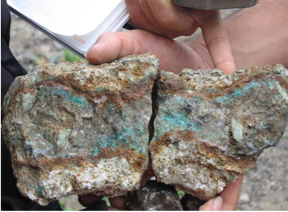
Şekil 2.16 a: Altere andezitler içerisindeki bir çatlak dolgu şeklinde gelişen Cu ve Fe getiriminin karbonat ve oksit gelişimini gösteren örnek.
