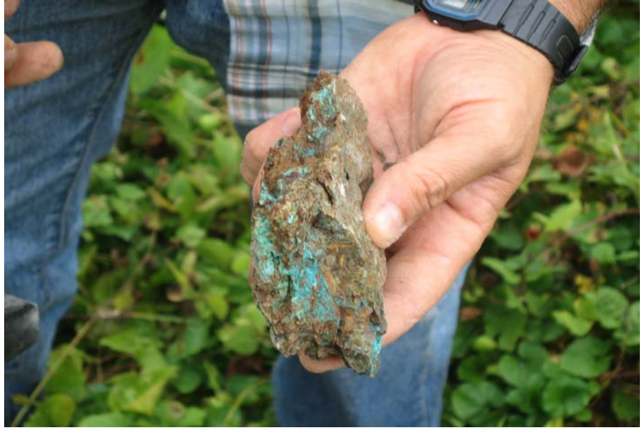
Şekil 2.17 a: Boşluk dolgusu şeklinde bakışımı gelişen ve olasılıkla gaz fazı getirimlerine işaret eden örnekler
