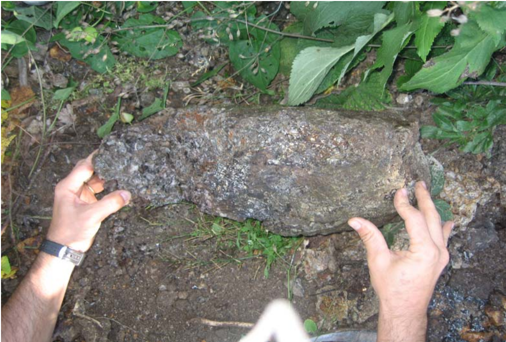
Şekil 2.17 h: Ayrışmış cevhersiz andezit ile Fe- Mn karbonat oksit getiriminin gözlemlendiği tektonik kontaklı örnek.
