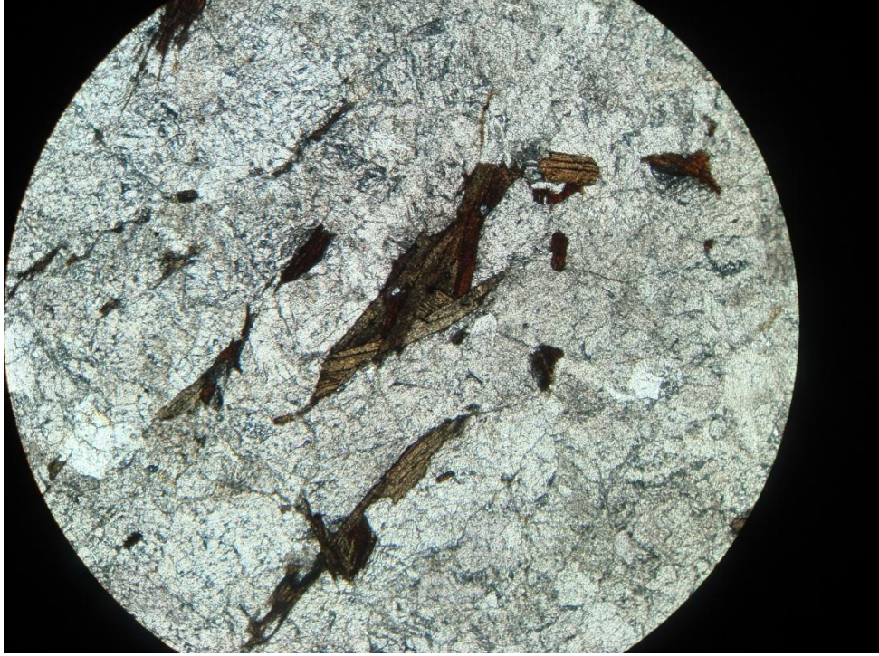
Şekil 3.1b: Çataldağ Graniti'nde gözlenen holokristalen granüler doku. Kaya dinamik metamorfizma etkisi ile yönlenme kazanmaya başlamıştır. ( Örnek no:350, 4 x, TN)
