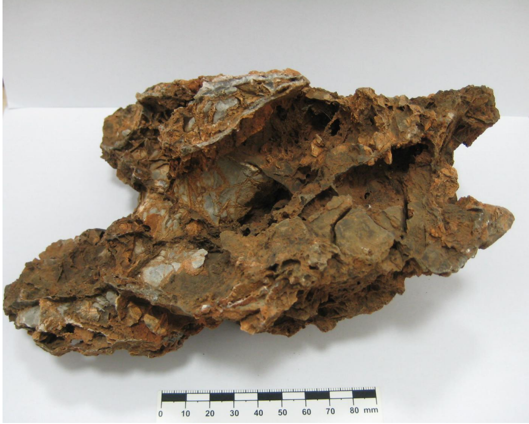
Şekil 4.20 Silisleşmenin ileri derecesi. Asidik sıvılar ile yıkanmış silisleşmiş kireçtaşı örneği. Kalıntı kireçtaşı parçaları silisleşme içinde rahatça seçilebilmektedir.
