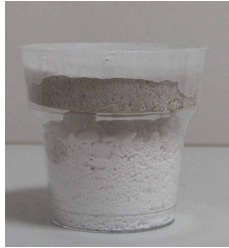
Şekil 3.5: Buhar geçirgenlik deney düzeneği
