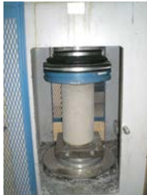
Şekil 3.27 : Sıva harcı standart basınç deneyi.
