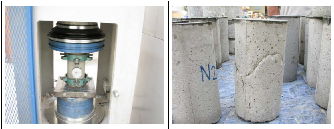
Şekil 2.15 : Beton harcı standart basınç deneyleri.
