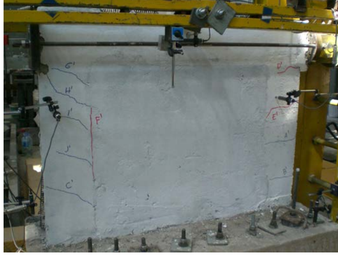
Şekil 3.61 : 5. çevrim sırasında oluşan çatlaklar.
