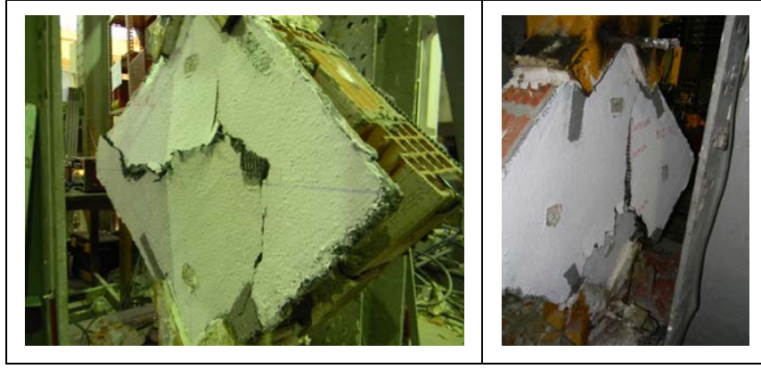
Şekil 2.44 : GN-2-2-3 numunesinin ön ve arka yüzlerinin göçme sonrası durumu.
