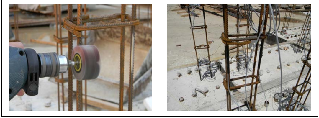
Şekil 3.8 : Şekildeğiştirme ölçer yapıştırma aşamaları.
