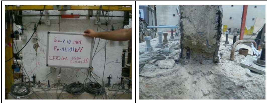
Şekil 3.98 : 10. çevrim sonunda numunedeki hasar durumu.
