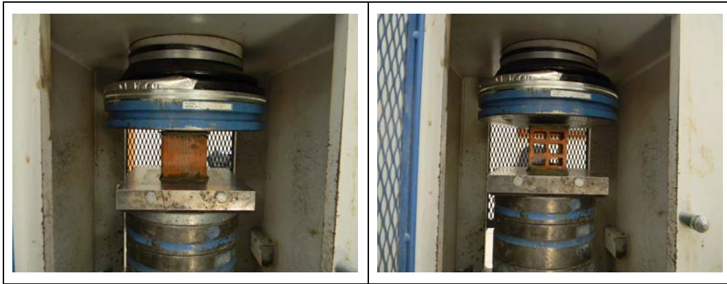
Şekil 3.28 : Tuğla standart basınç deneyi.
