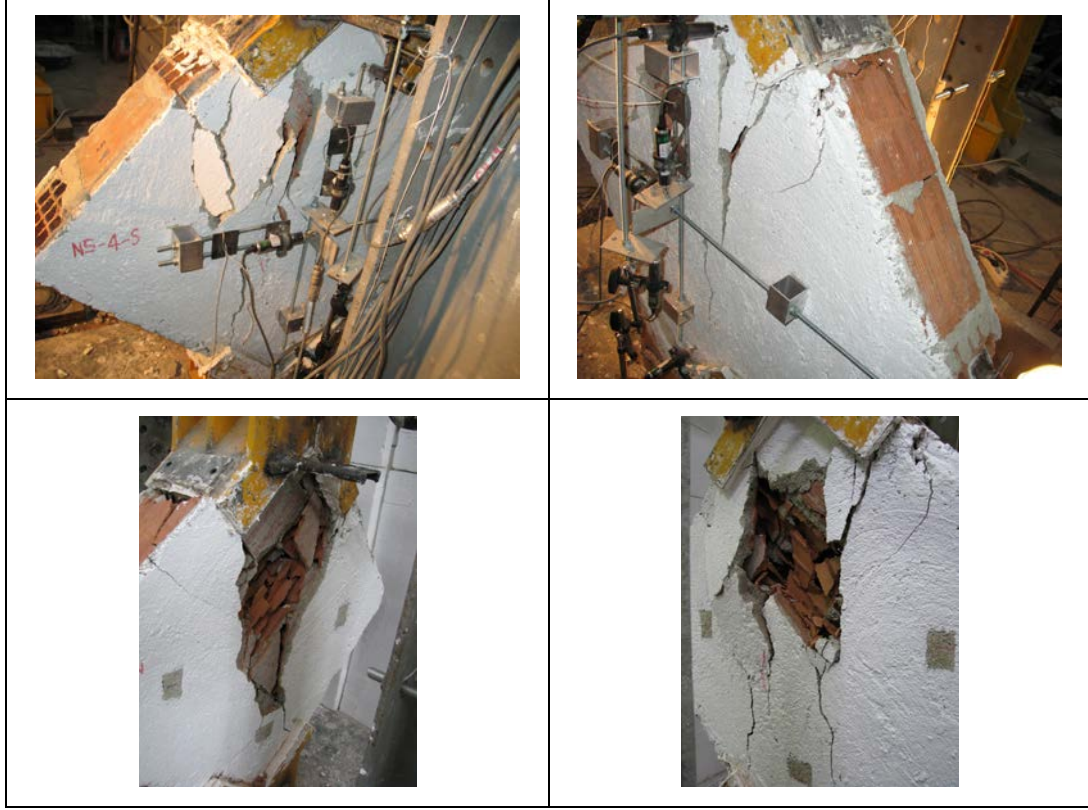
Şekil 2.21 : KN-3 numunesinin ön ve arka yüzlerinin hasar durumu.
