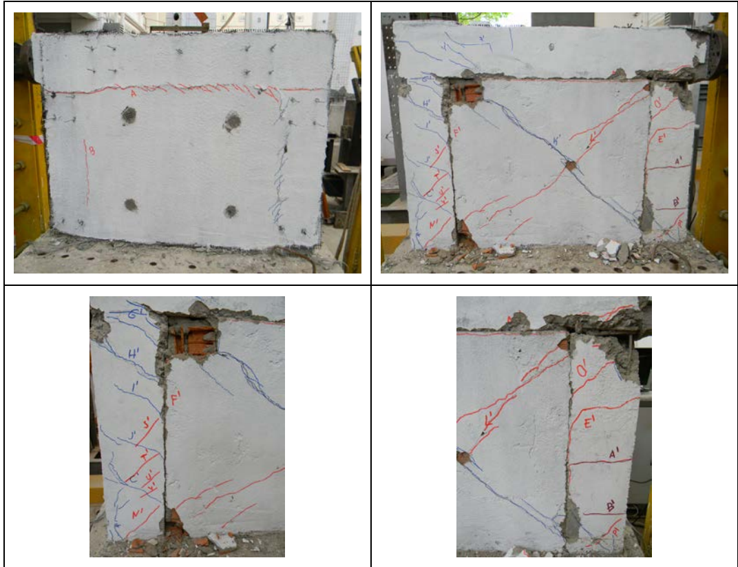
Şekil 3.68 : 13. çevrim sonunda numunenin durumu.
