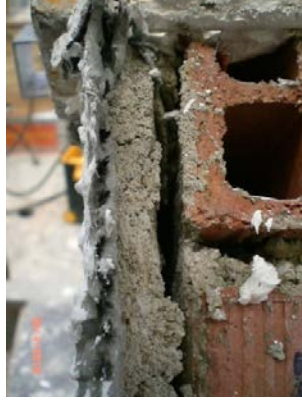
Şekil 2.25 : GN-1-1-3 numunesinde sıvanın ayrışması.
