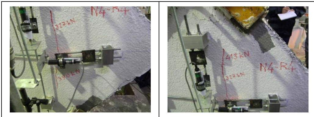
Şekil 2.43 : GN-2-2-3 numunesinin oluşan çatlaklar.
