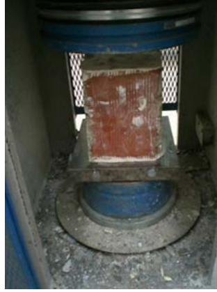
Şekil 2.16 : Duvar numunelerindeki tuğlaların basınç deneyleri.
