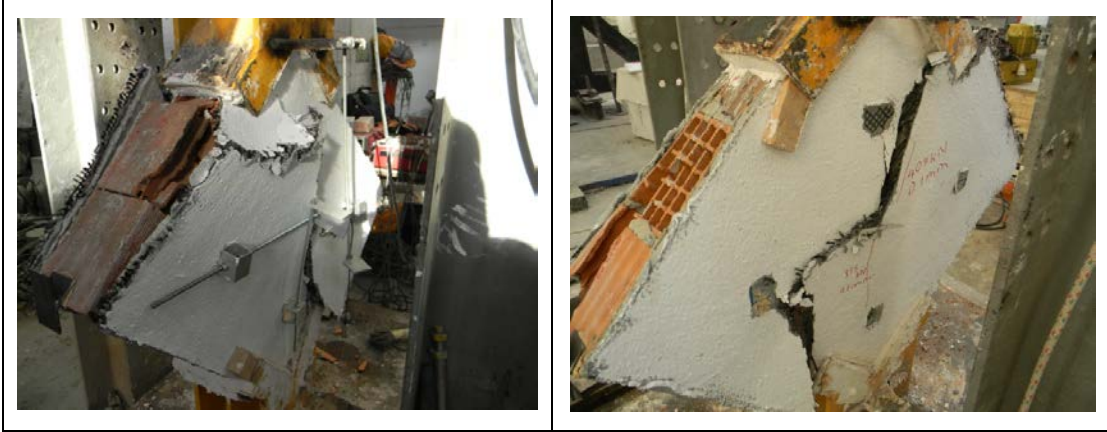
Şekil 2.29 : GN-2-1-1 numunesinin ön ve arka yüzlerinin göçme sonrası durumu.
