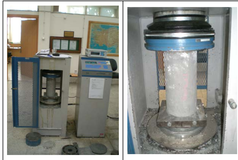
Şekil 3.29 : CFRC harcı basınç deneyleri.
