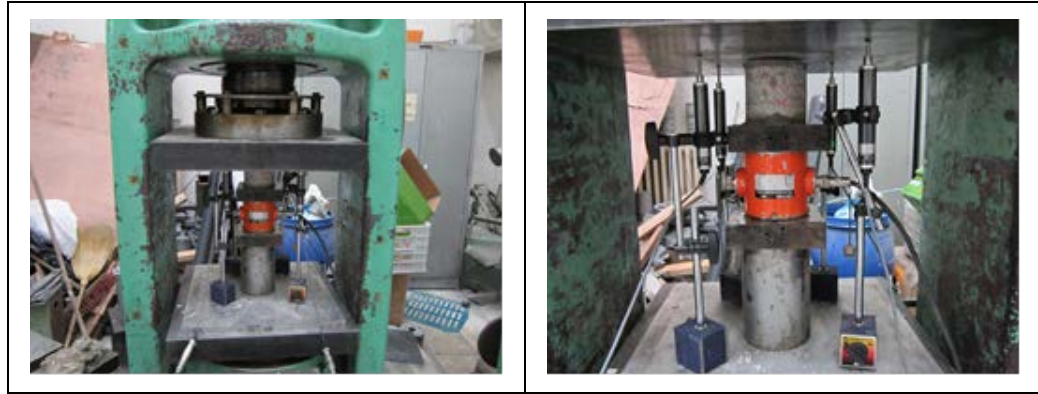
Şekil 3.26 : Beton gerilme-şekil değiştirme deney düzeneği.
