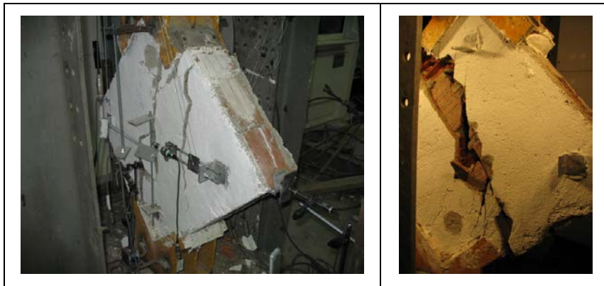
Şekil 2.20 : KN-2 numunesinin ön ve arka yüzlerinin göçme sonrası durumu.
