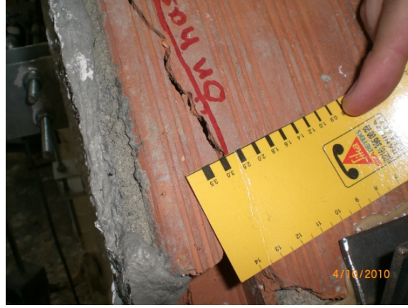
Şekil 2.28 : 262 kN'da 3mm ye ulaşan çatlak.
