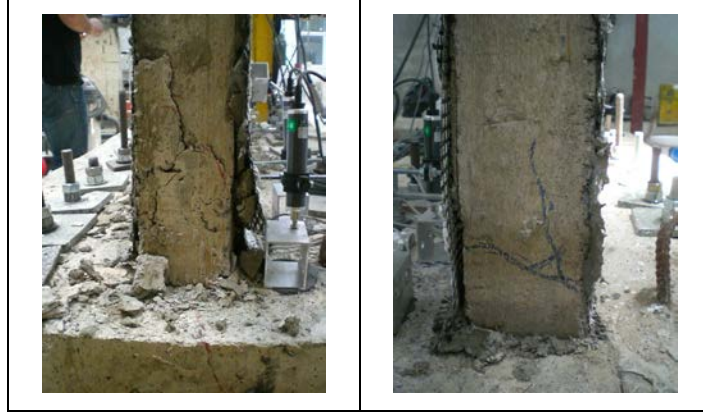
Şekil 3.104 : 11. çevrim sırasında oluşan çatlaklar.
