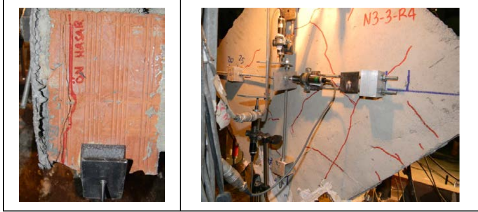
Şekil 2.37 : GN-1-2-3 numunesindeki ön hasarlar.
