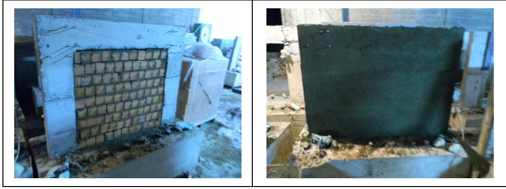
Şekil 3.12 : Betonarme çerçevelerin iki yüzünün sıvanması.
