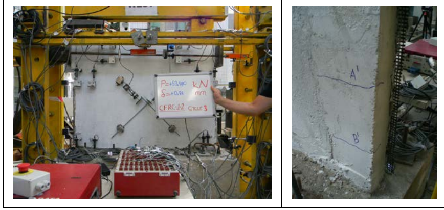
Şekil 3.59 : 3. çevrim sırasında oluşan çatlaklar.
