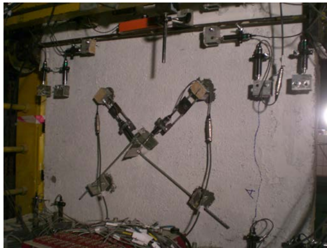
Şekil 3.82 : 4. çevrim sırasında oluşan çatlak.
