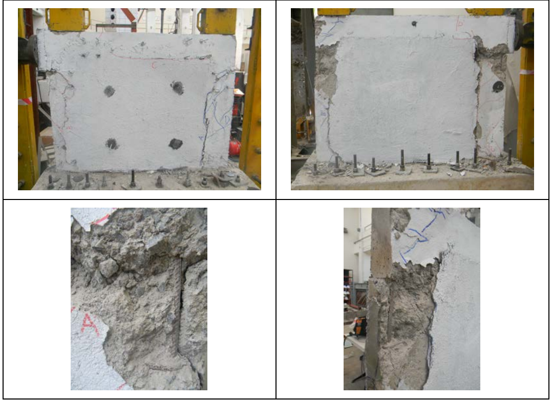
Şekil 3.89 : Çevrim sonunda numunenin hasar durumu.
