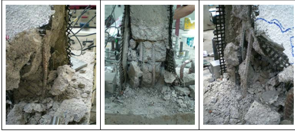
Şekil 3.106 : Son çevrimlerde gözlemlenen donatı burkulmaları.
