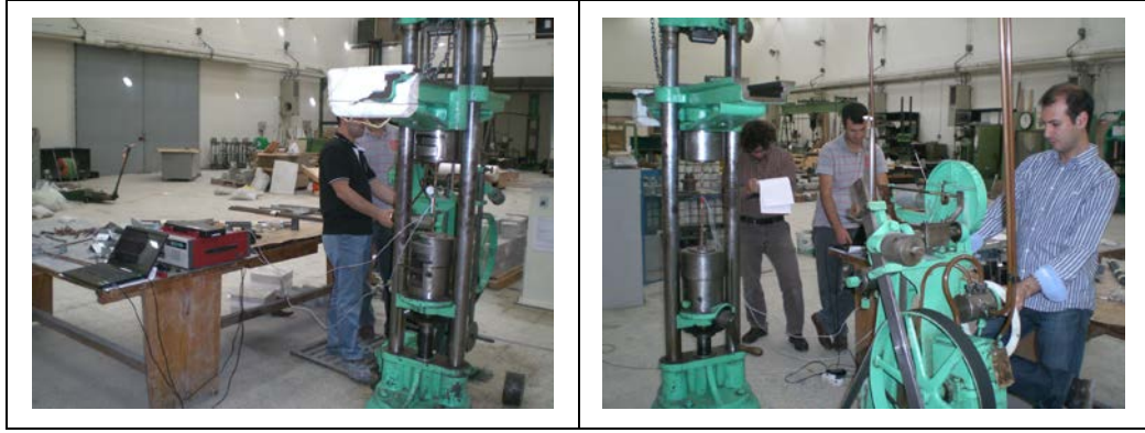
Şekil 3.25 : Standart donatı çekme deney düzeneği.
