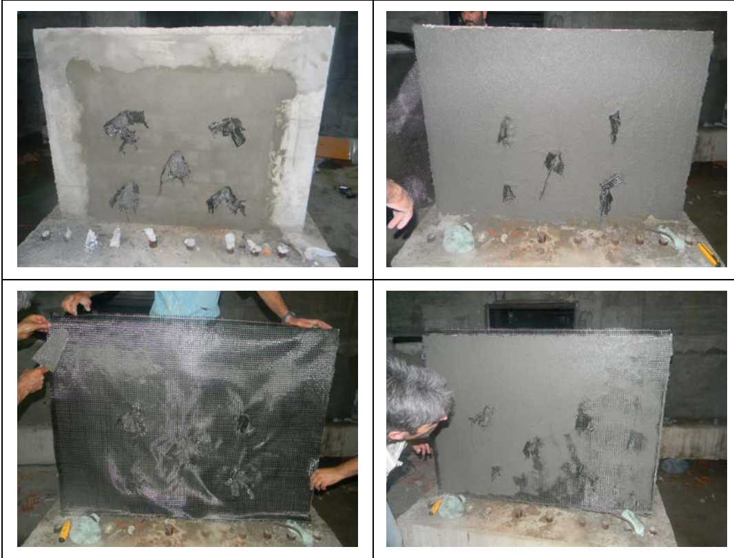
Şekil 3.15 : Ankrajlı CFRC uygulaması.
