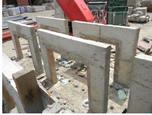
Şekil 3.2 : Üretilen betonarme çerçeve numuneleri.
