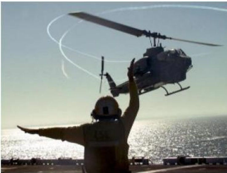
Şekil 1.4 : AH-1W Super Cobra Helikopterinin Oluşturduğu Uç Girdapları [29]
