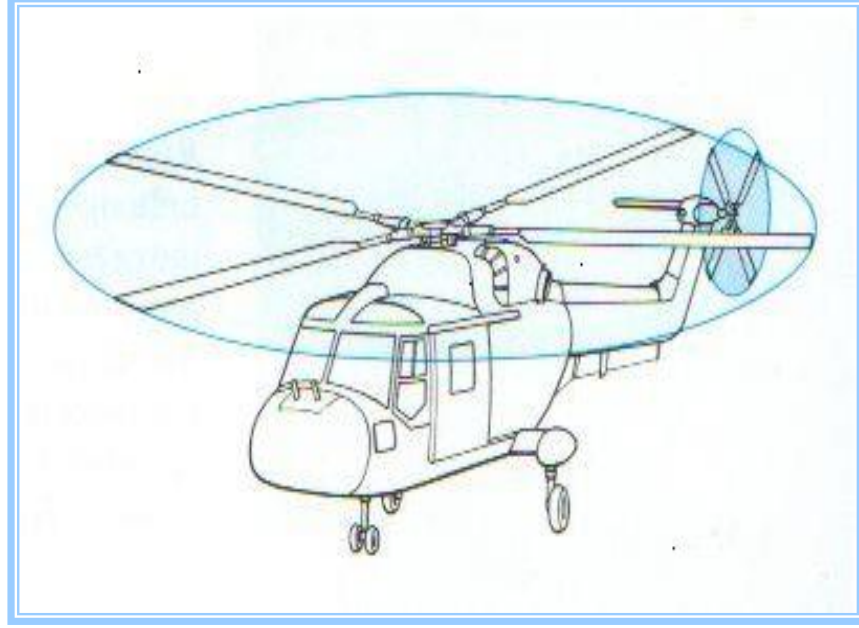
Şekil 2.2 Kuyruk rotorlu klasik helikopter [24]
