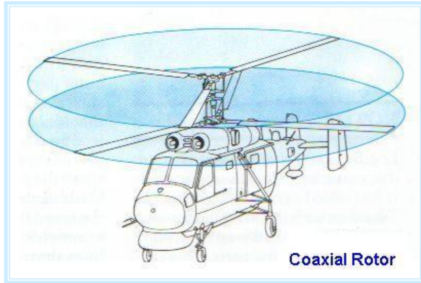
Sekil 2.3 Kuyruk rotorsuz helikopter [24]
