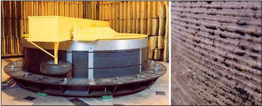
Şekil 5.20 : Tekerlek lastiği-kaplama test ekipmanı ve örnek bir kaplama yüzeyi [34].
