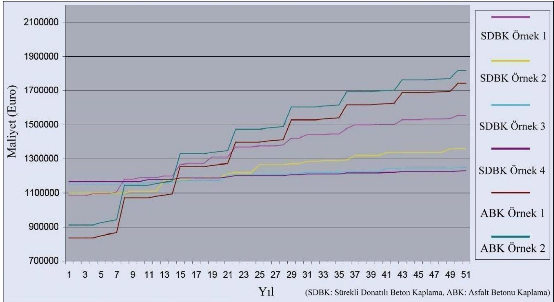
Şekil 3.20 : Sürekli donatılı beton ve asfalt betonu kaplamalı yolların ilk yapım ve bakım maliyetlerini gösteren grafik [27].
