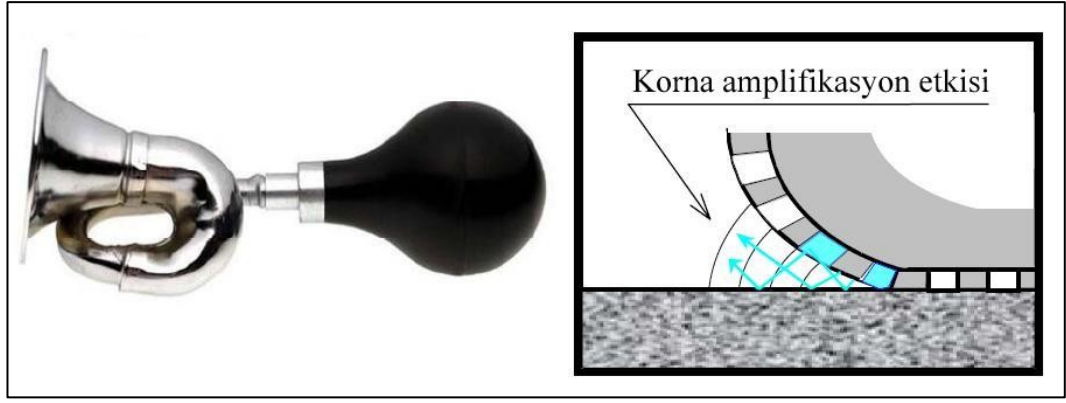
Şekil 5.14 : Korna amplifikasyon mekanizması [34].
