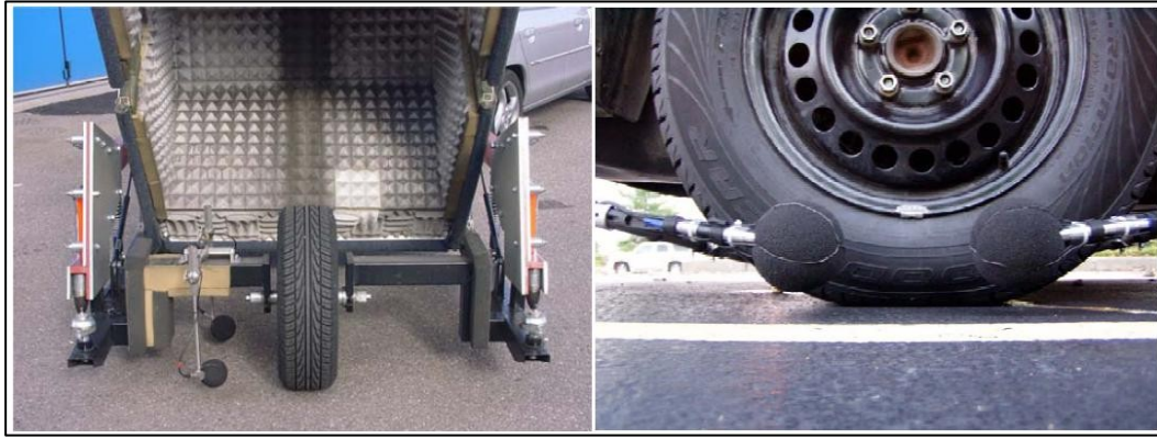
Şekil 5.19 : Kapalı yakınlık (solda) ve araca monteli ses şiddeti ölçme (sağda) yöntemi test ekipmanları [34].
