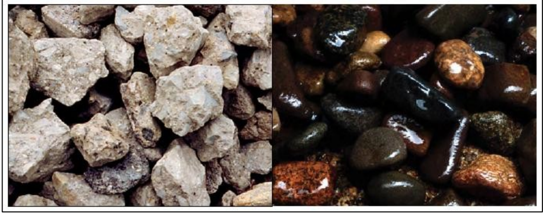
Şekil 3.10 : Kırma taş agregası (solda) köşeli şekilli ve nehir yatağından elde edilen agregası (sağda) daha köşeli şekilli [11].
