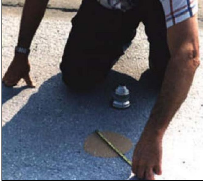
Şekil 4.6 : Ottawa kumu kullanılarak yapılmış kum yama yöntemi [29].
