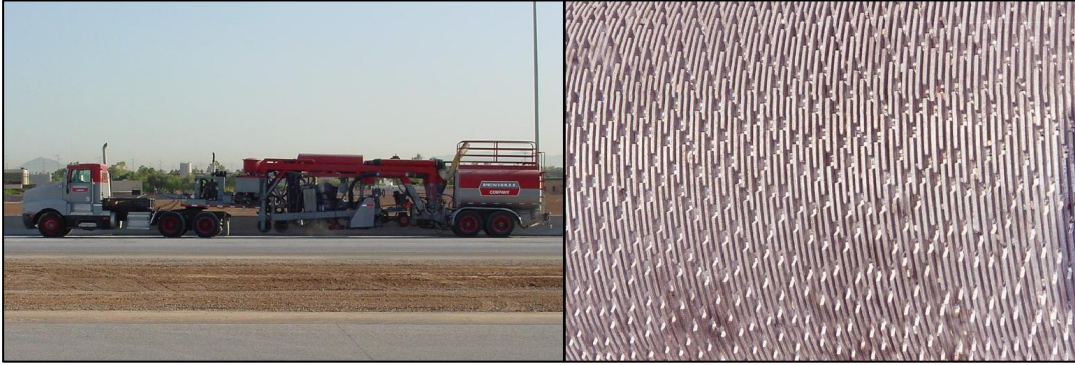
Şekil 6.10 : Aşındırma yönteminde kullanılan elmaslı testere ağızları (sağda) ve bu ağızların yerleştirildiği ekipman (solda) [40].
