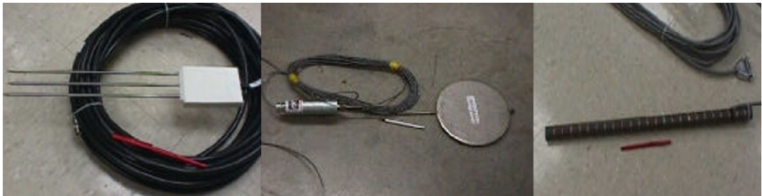
Şekil 6.13: Esnek Üstyapı Sıcaklık Ölçüm Sensörleri
