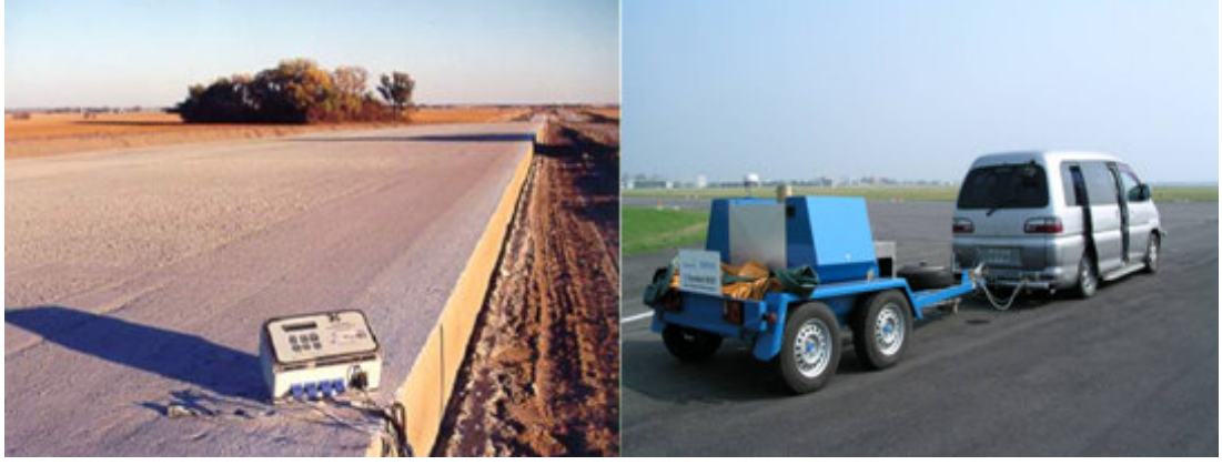
Şekil 6.9: Rijit ve Esnek Üstyapıda Kullanılan NDT Cihazları
