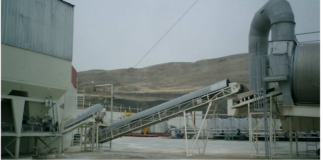
Şekil 2.11: Bunker Altı Toplama Bandı ile Beslenen Kurutucu Yükleme Bandı (Çetin İşletmeleri, Ağırıklı Tip Asfalt Plenti, Ankara)
