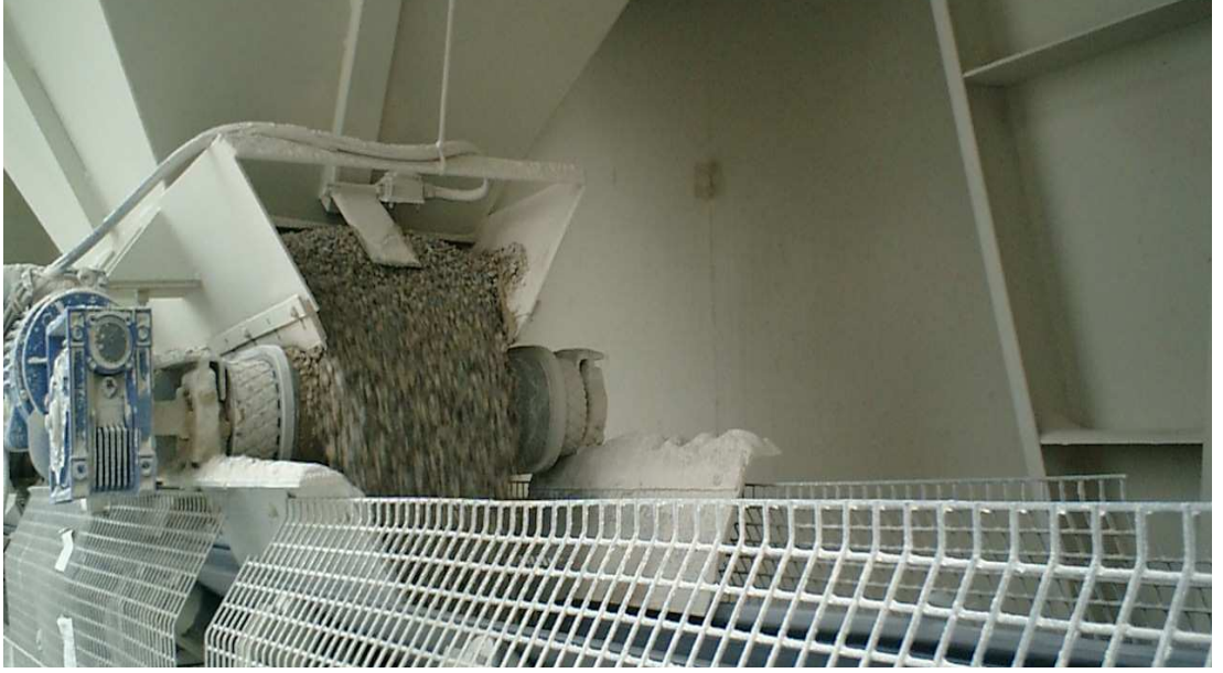
Şekil 2.10: Vargelli Besleyici ile Beslenen Bunker Altı Toplama Bandı (Çetin İşletmeleri, Ağırıklı Tip Asfalt Plenti, Ankara)
