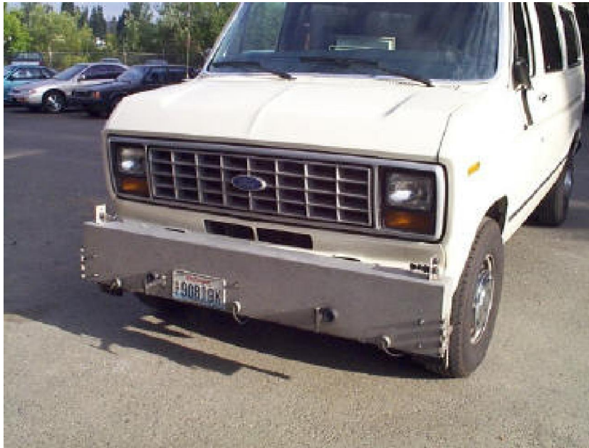
Şekil 3.5 : Ultrasonik profilometri aracı (Ur1-1).
