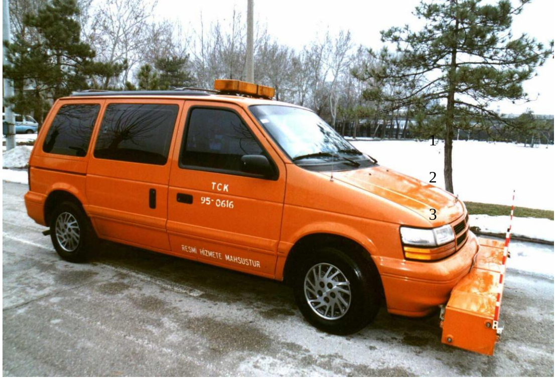
Şekil 3.7: TCK tarafından kullanılan profilometre aracı
