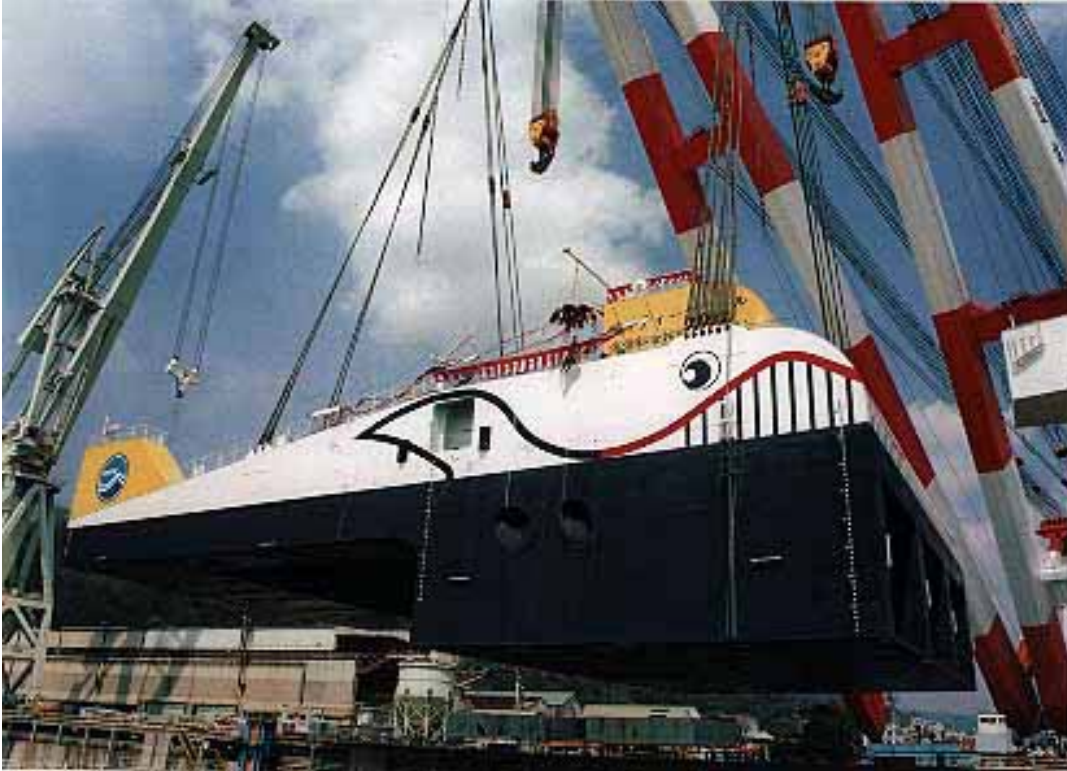
Şekil 1.12.1 Büyük balina (mighty whale) enerji dönüşüm sisteminin prototipi suya indirilmek üzere
