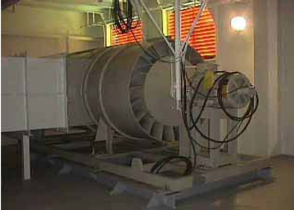
Şekil 1.10.5 Büyük balina (mighty whale) enerji dönüşüm sisteminin prototipine ait jeneratör
