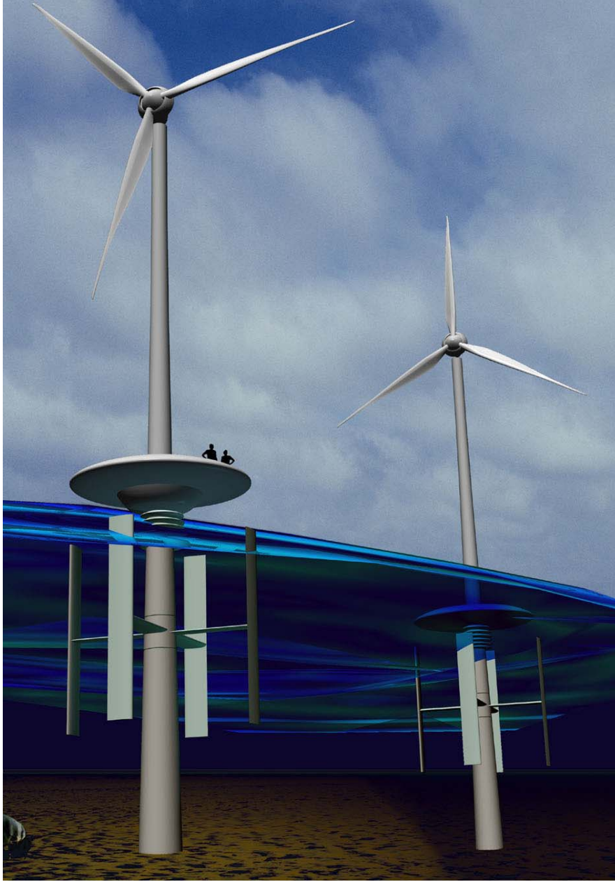
Şekil 1.7 Su altındaki su çarkları ve su üstündeki rüzgar gülü ile Ecofys Enerji Dönüşüm Sistemi
