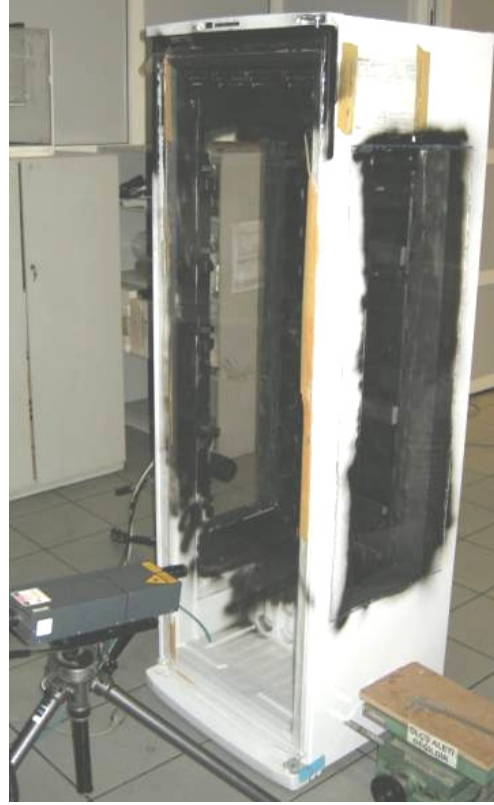
Şekil 3-5: PIV deneyine alınan dolabın görüntüsü
