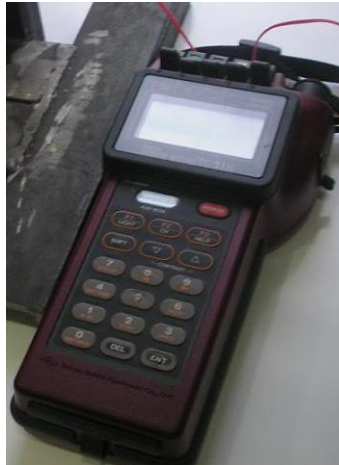
Şekil 4.5: TC-31K statik gerinim ölçüm cihazı.
