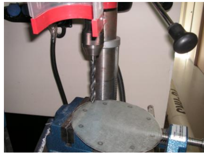
Şekil 5.9: Cam/Epoksi membranların hazırlanması.
