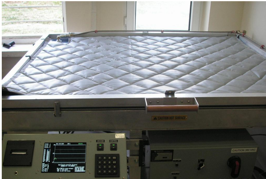
Şekil 3.2 : Heatcon marka kompozit imalat masası.
