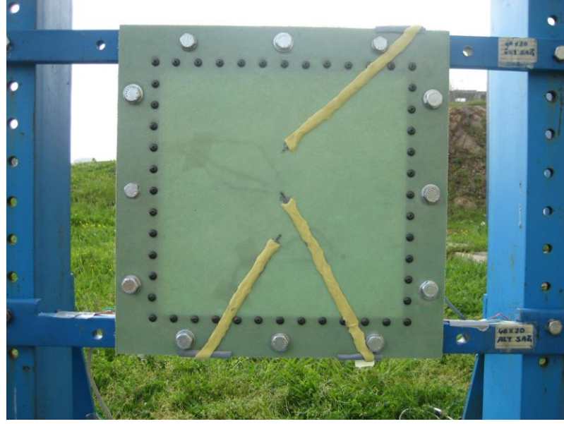
Şekil 5.6: Basınç duyargalarının konumları ve koruma altına alınması.
