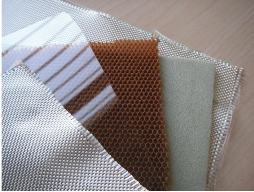
Şekil 3.1 : Sandviç plak malzemelerinin işlenmemiş hali.
