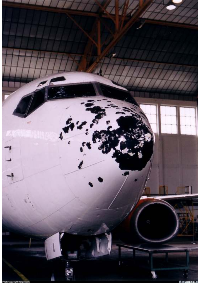
Şekil 3.11 : Kuş sürüsüne girmiş bir uçağın burun kısmı ve kokpit camı.
