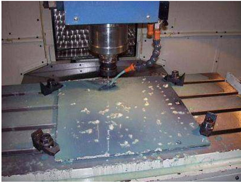
Şekil 3.16 : Kompozit plağın CNC tezgâhında işlenmesi.
