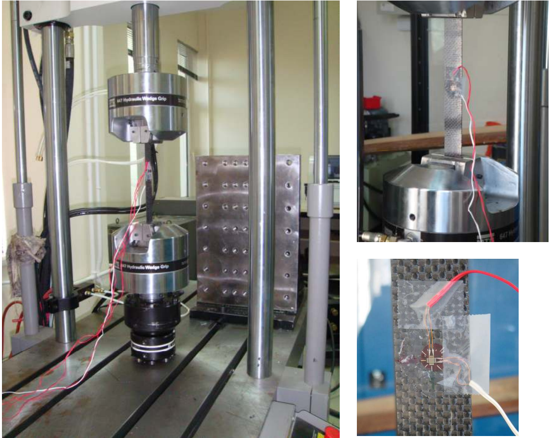
Şekil A.14 : Deney numunesinin MTS cihazına bağlantısı ve numuneye yapıştırılmış gerinim ölçer görünüşü.
