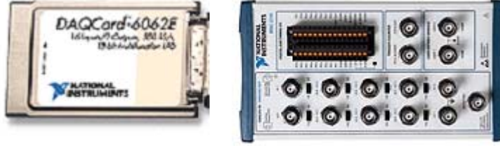
Şekil 5.6 : 6062E veri toplama kartı ve BNC-2110 terminali.
