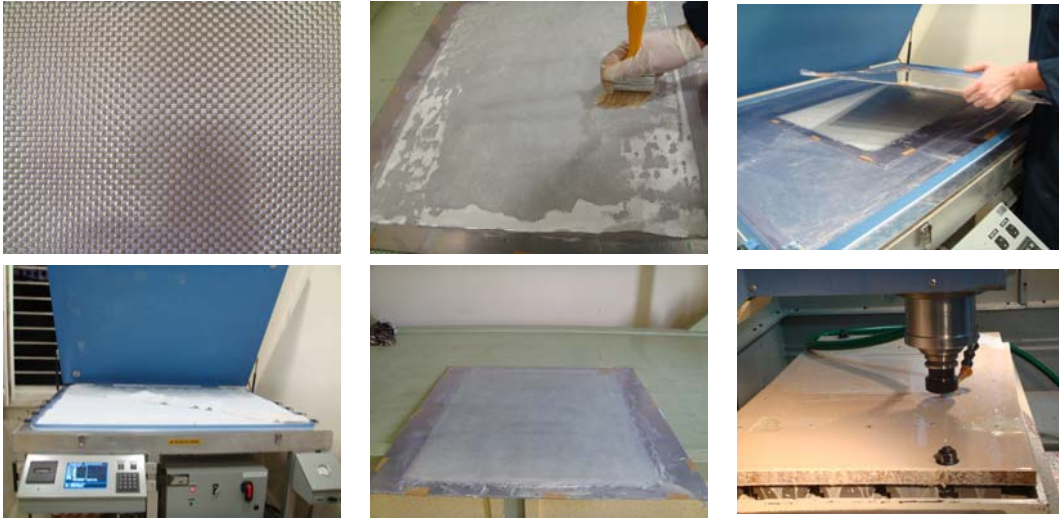
Şekil 5.1 : Katmanlı kompozit kirişin imalat aşamaları.
