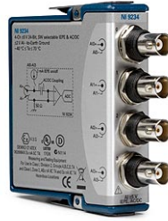
Şekil 5.9 : NI 9234 Veri toplama kartı.
