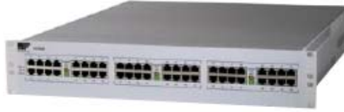
Şekil 5.8 : EX 1629 gerinim ölçüm cihazı.
