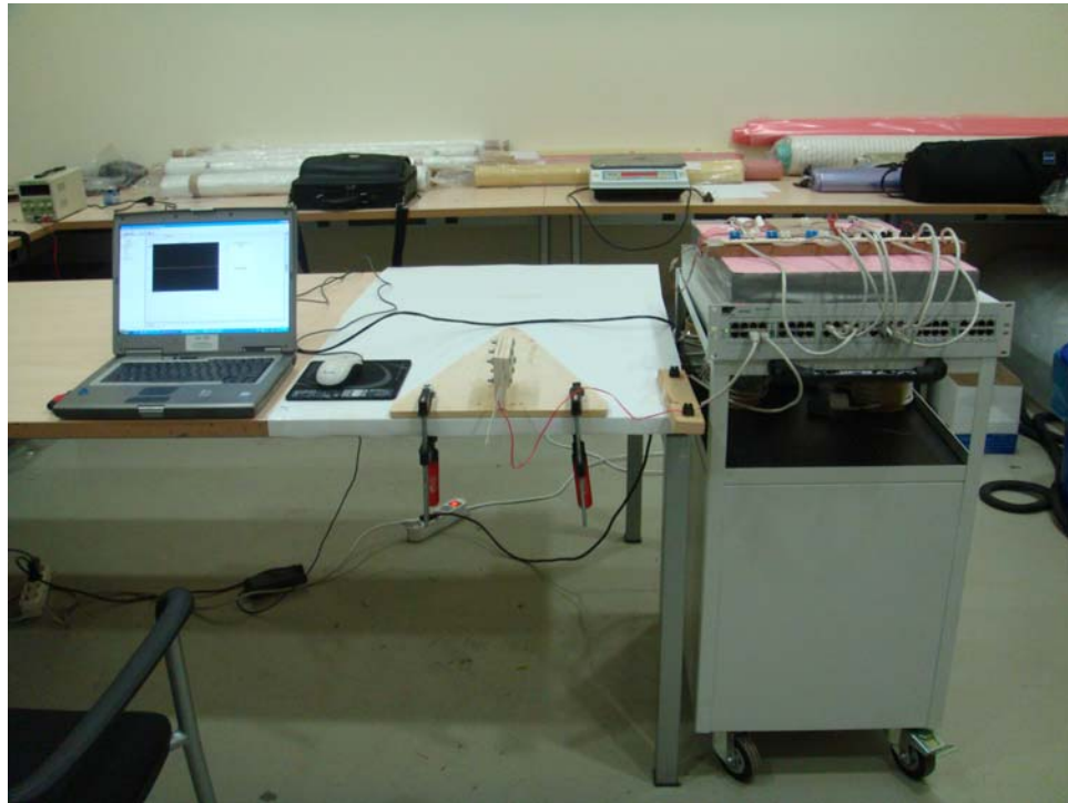
Şekil 5.13 : Dinamik gerinim ölçümü deney düzeneği.
