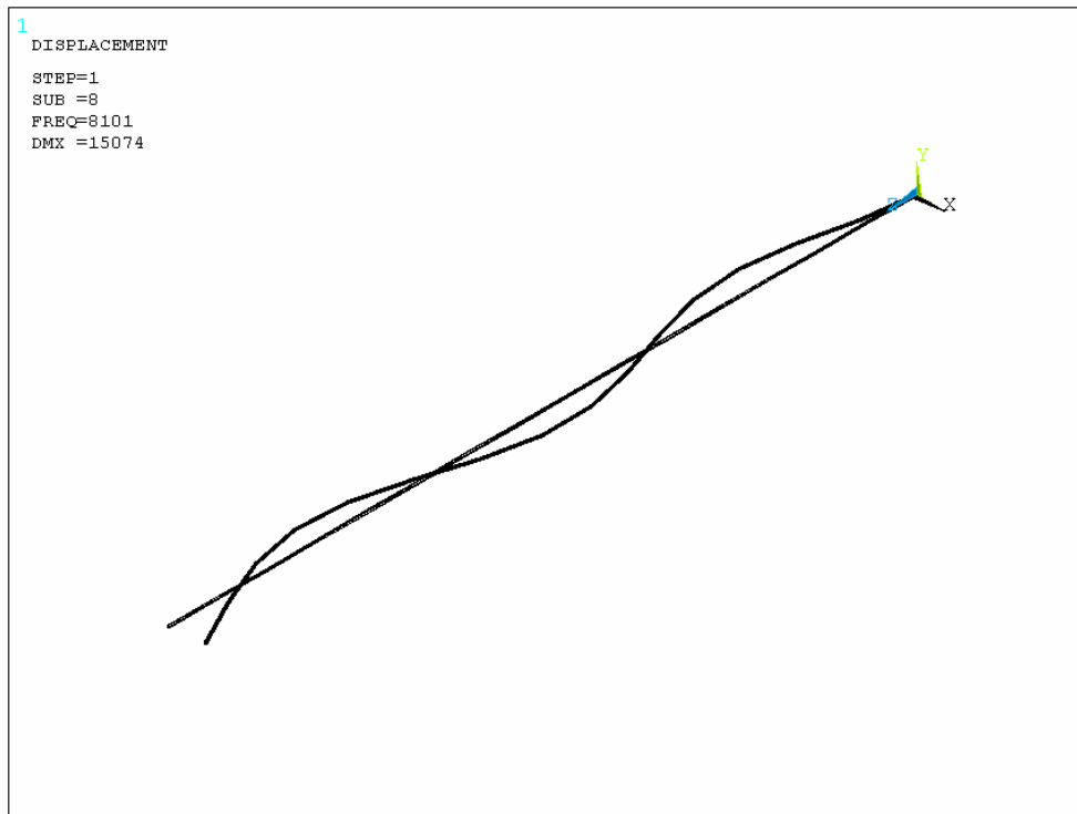
Şekil Ek J.8: Cam elyaf serbest titreşim analizi 8. frekans şekli
