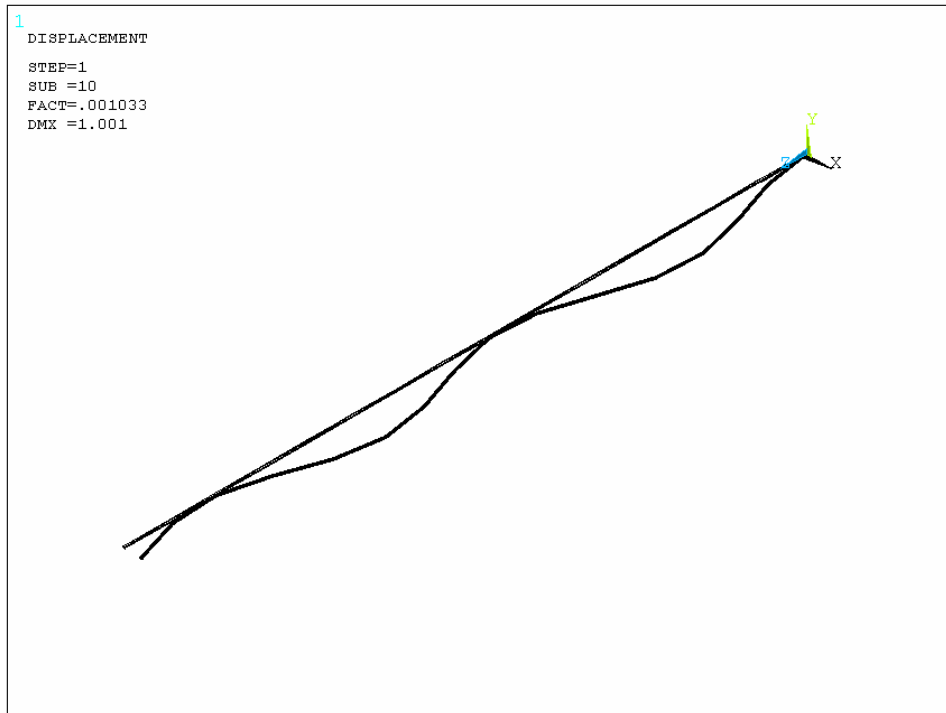
Şekil Ek K.10: Ortotropik malzeme kullanılarak yapılan karbon elyaf analizi 10. mod şekli
