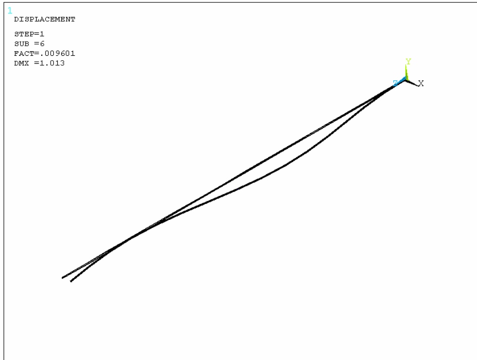
Şekil Ek M.6: İzotropik malzeme kullanılarak yapılan karbon elyaf analizi 6. mod şekli
