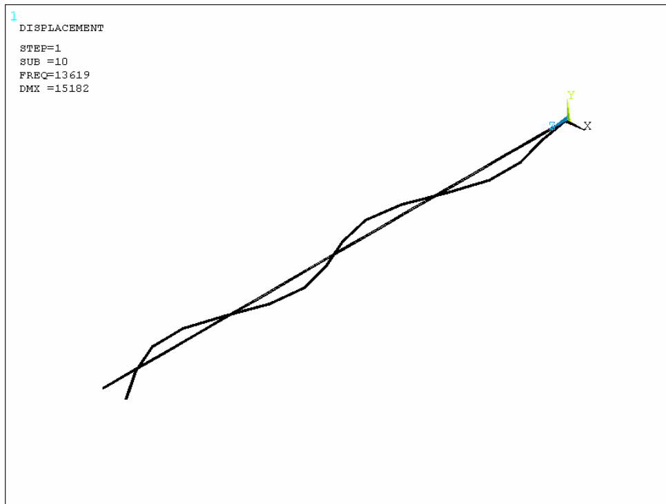
Şekil Ek J.10: Cam elyaf serbest titreşim analizi 10. frekans şekli
