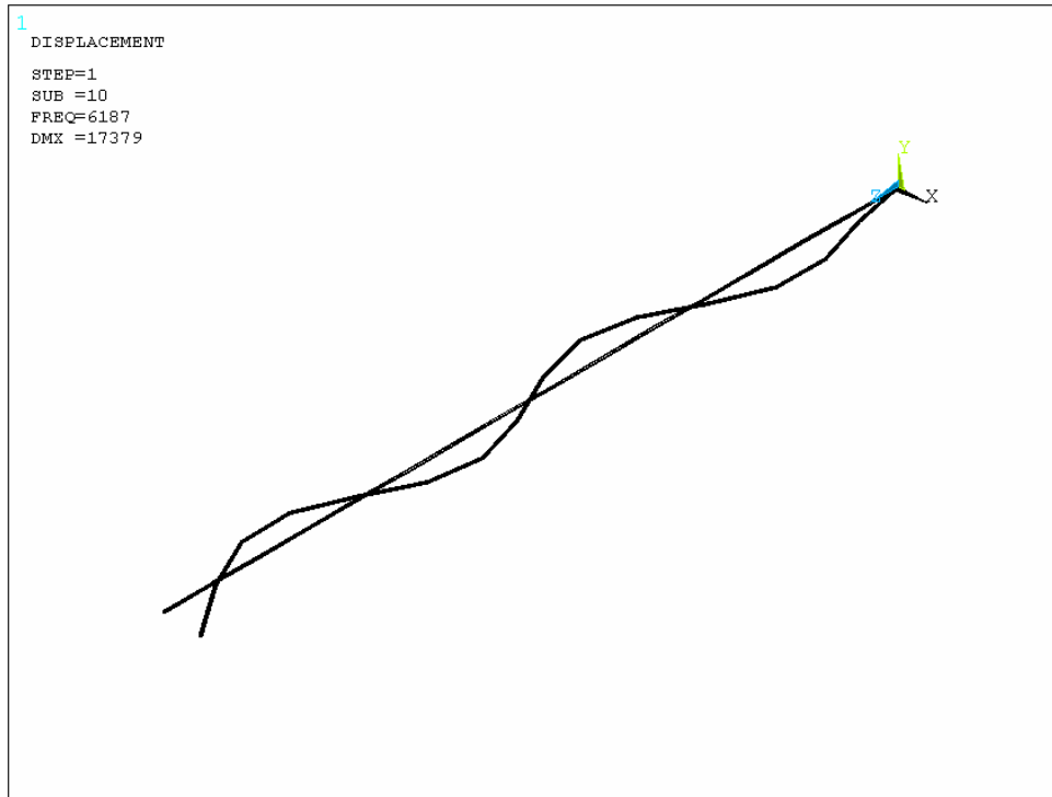
Şekil Ek L.10: Ortotropik malzeme kullanılarak yapılan karbon elyaf serbest titreşim analizi 10. frekans şekli
