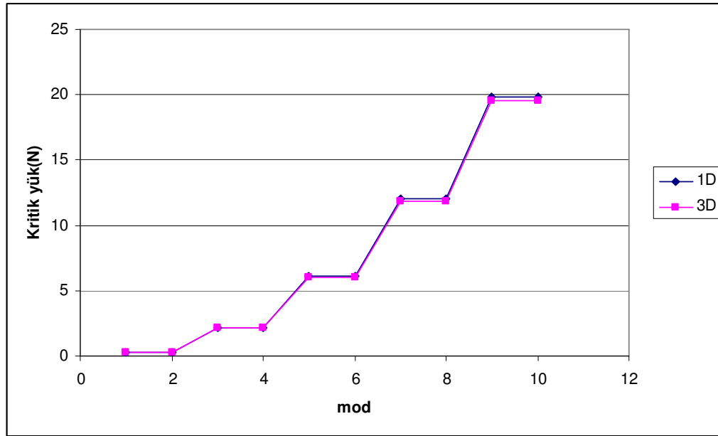
Şekil 4.1: Bir boyutlu ve üç boyutlu elyaf analizi kritik yük grafiği
