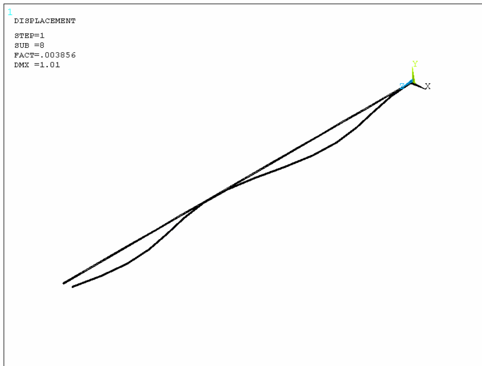
Şekil Ek I.8: Cam elyaf analizi 8. mod şekli
