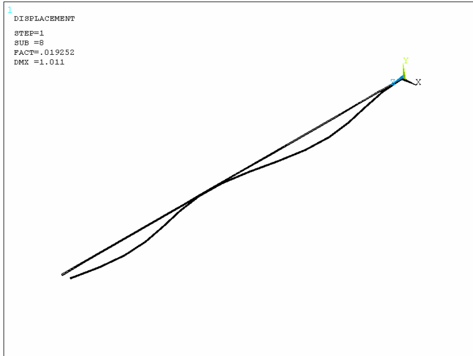
Şekil Ek M.8: İzotropik malzeme kullanılarak yapılan karbon elyaf analizi 8. mod şekli
