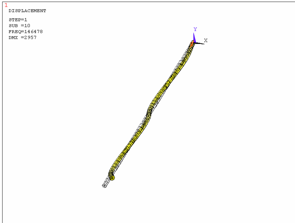
Şekil Ek C.10: Üç boyutlu bor elyaf serbest titreşim analizi 10. frekans şekli
