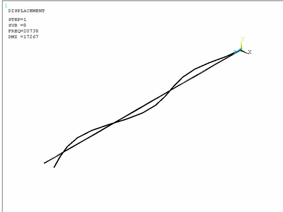
Şekil Ek D.8: İzotropik malzeme kullanılarak yapılan karbon elyaf serbest titreşim analizi 8. frekans şekli
