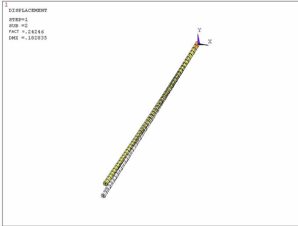
Şekil Ek B.2: Üç boyutlu bor elyaf analizi 2. mod şekli
