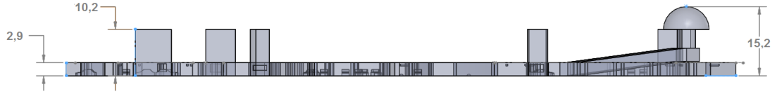
Şekil 5.5: Model geometrisinin yan görünüşte metre cinsinden boyutları ve kat yüksekliği detayı.
