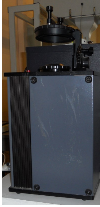
Şekil 4.42 : Sıcak tel probu kalibrasyon ünitesi.
