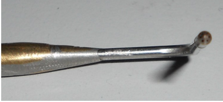
Şekil 2.12 : 7 Delikli basınç probu.
