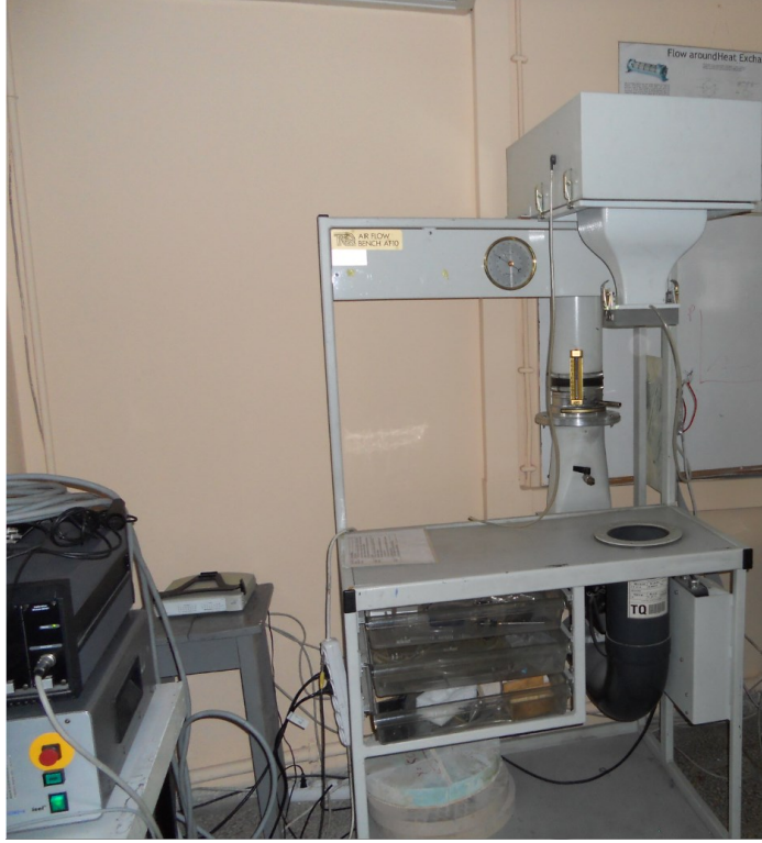
Şekil 4.44 : Deneyde kullanılan hava jet masası.
