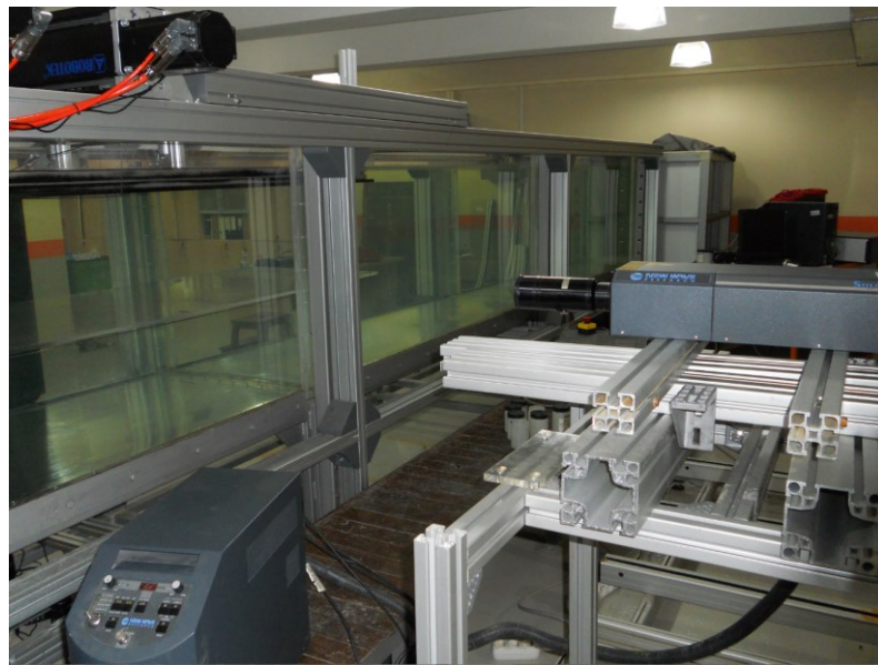
Şekil 2.9 : Travers üzerinde PIV lazer kaynağı.
