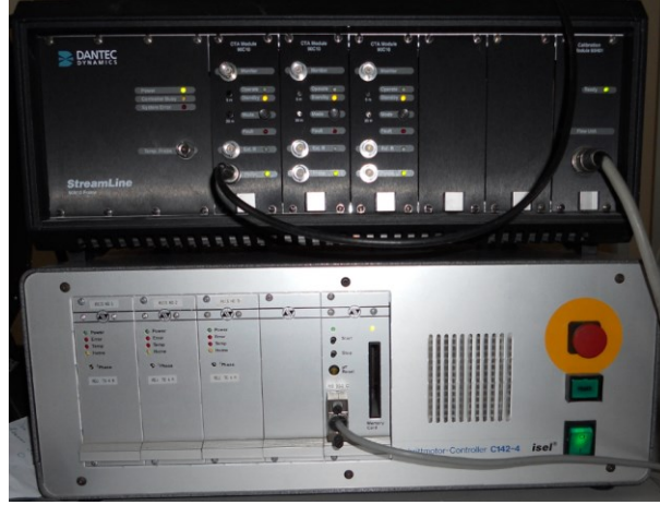
Şekil 4.40 : Sıcak tel anemometre ölçüm ve traverse kontrol ünitesi.
