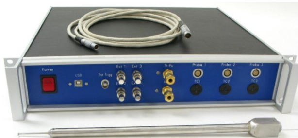
Şekil 2.13 : Hızlı cevaplı prob, bağlantı kablosu ve destek modülü.
