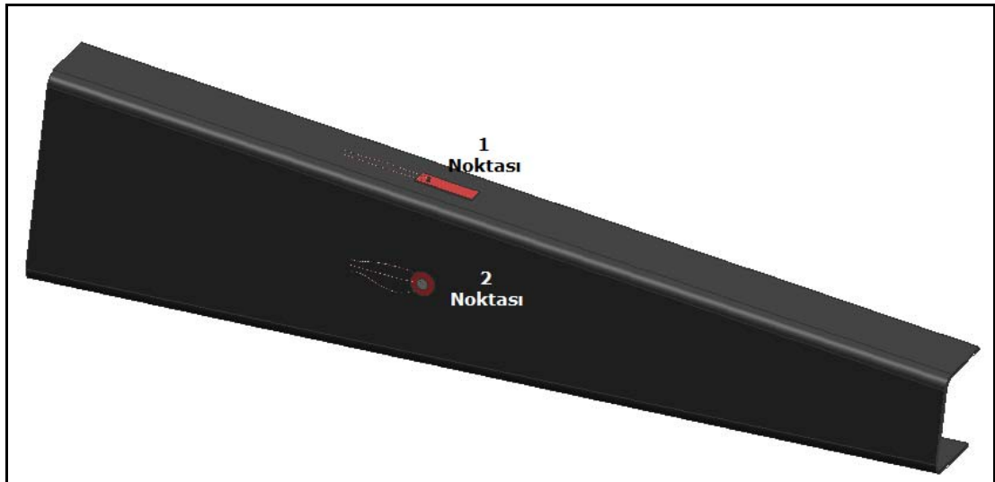
Şekil 4.4: Parçanın Modeli, Gerinim Pulu ve Rozetin Konumları
