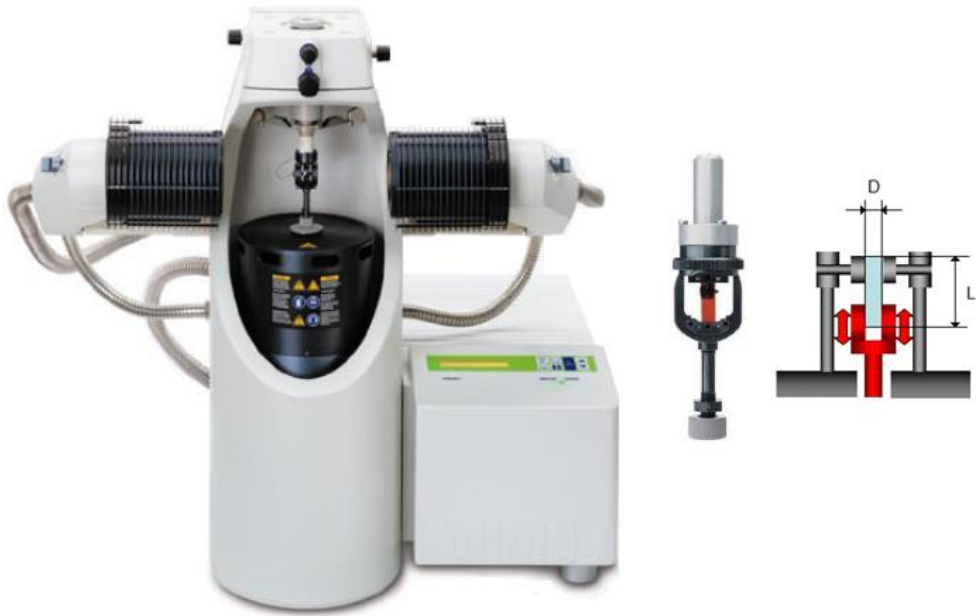
Şekil 4.12 : Mettler Toledo DMA SDTA861 cihazı ve gerilme modülü (D=lif çapı, L=Çene mesafesi) [137].
