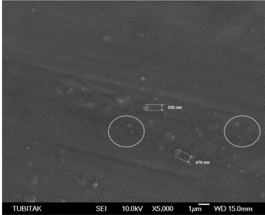
Şekil 5.21 : PPAg-3 monofilamentin kesit görüntüsü (x5000).
