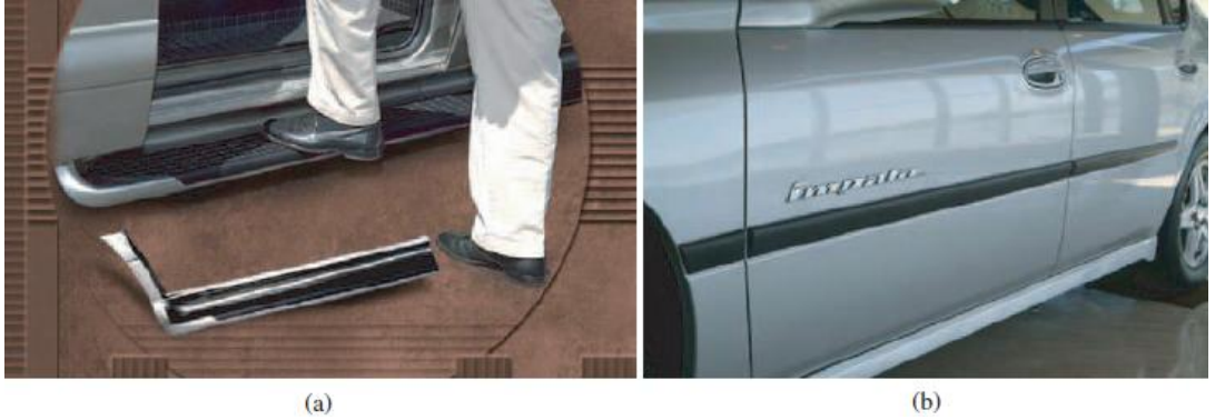
Şekil 2.17 : PP/kil nanokompozitlerinin otomobil parçalarında kullanımı: (a) M-Van basamak (ilk ticari kullanım) ve (b) Impala [38].
