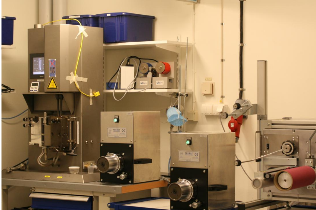
Şekil 4.3 : DSM Xplöre 15 Mikrokomponenter ile monofilament üretim sistemi.
