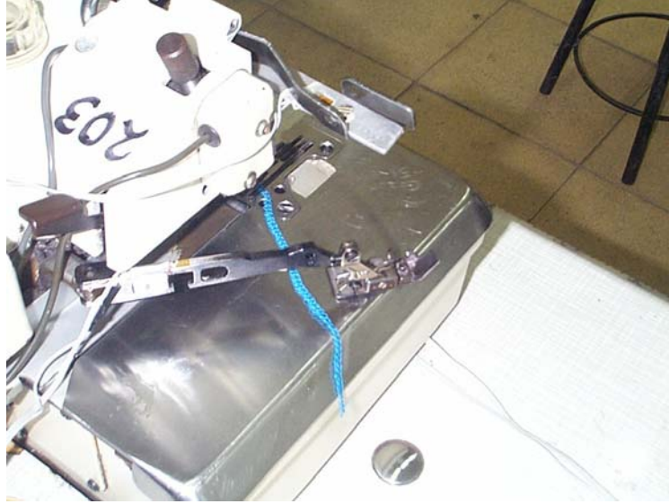
Şekil 3.13: Strain gauge'ler ile donatılmış baskı ayağı çubuğu
