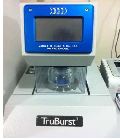
Şekil 5.5: Patlama mukavemeti ölçüm cihazı.
