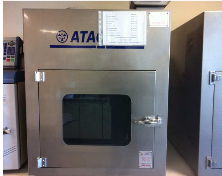
Şekil 5.2: Numune boyama makinası dış görünüşü.
