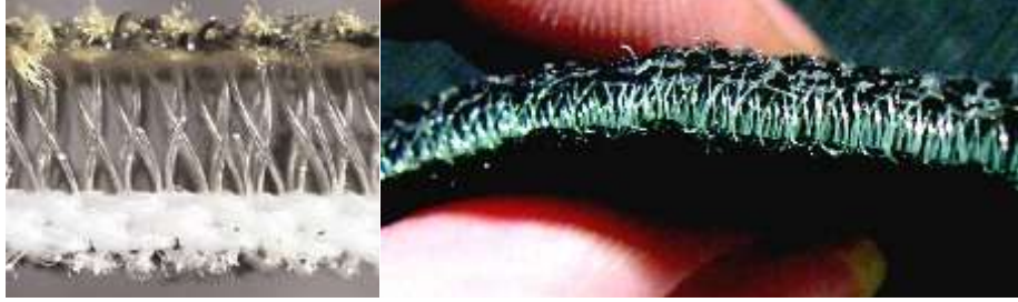
Şekil 4.6 : Yuvarlak örme makinasında üretilen sandviç kumaş yapıları [38].
