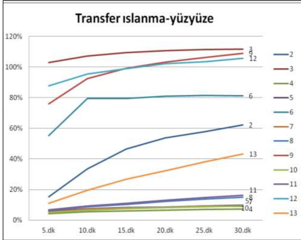
Şekil 5.42 : Her iki yüzü pamuk kumaşların yüzyüze transfer ıslanma oranları.
