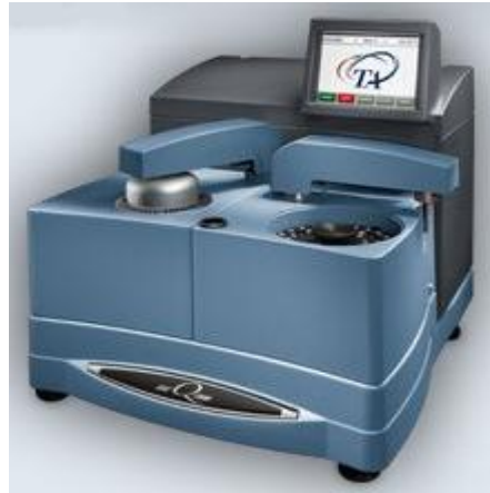
Şekil 5.6 : Diferansiyel taramalı kalorimetre [54].
