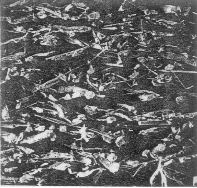
Şekil 4.27. Ağaç hamuru , polyester ve mikro cam elyafından yapılmış yağ filtresinin kesit görünümü
