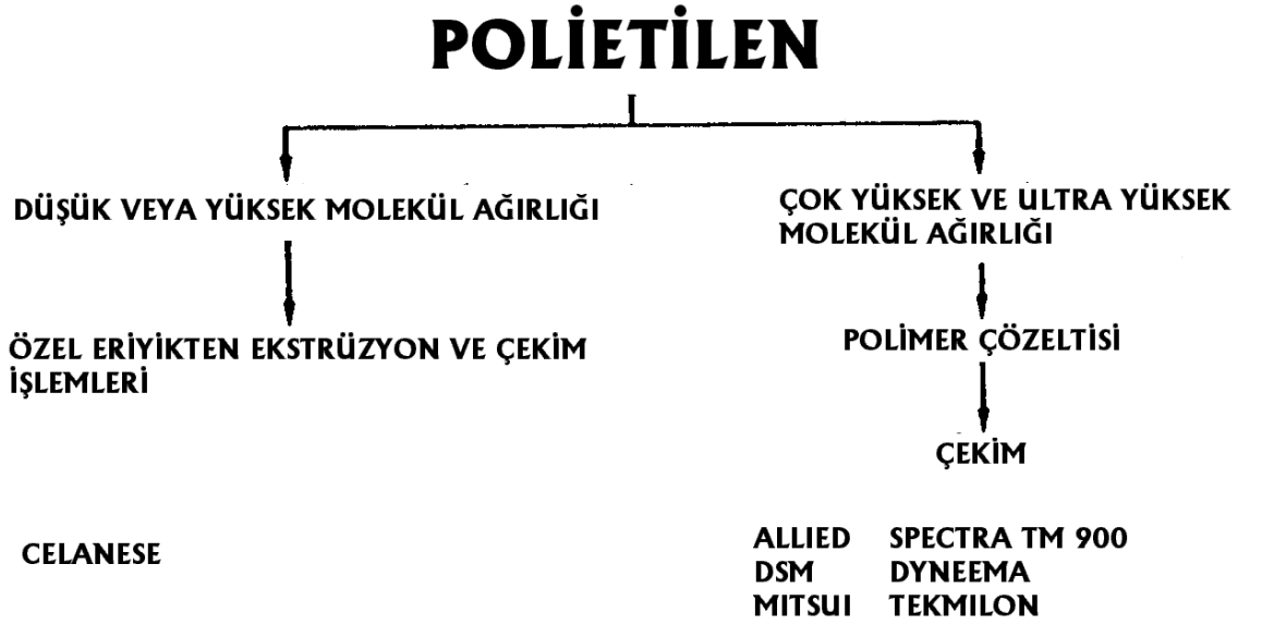
Şekil 2.37.Yüksek performans PE lifi elde etmek için izlenmesi gereken yollar
