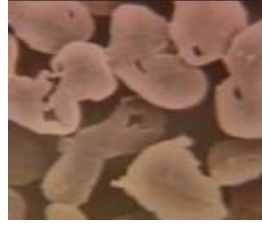
Şekil 3.9: Soya Lifinin Enine ve Boyuna Kesit Görüntüleri
