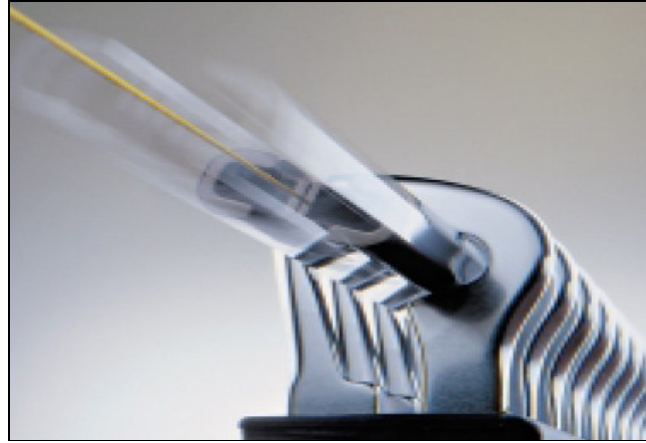
Şekil 1.5: Mekikçikli tezgahta mekikçik ile atkının atılması [24]
