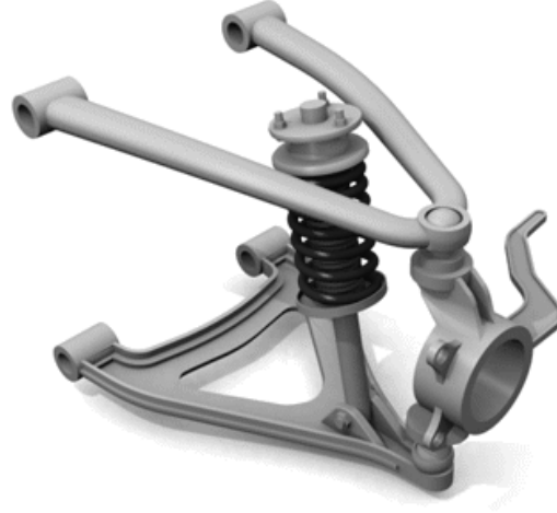
Şekil 1.1 : Çift lades kemiği tipi süspansiyon (Url-4)
