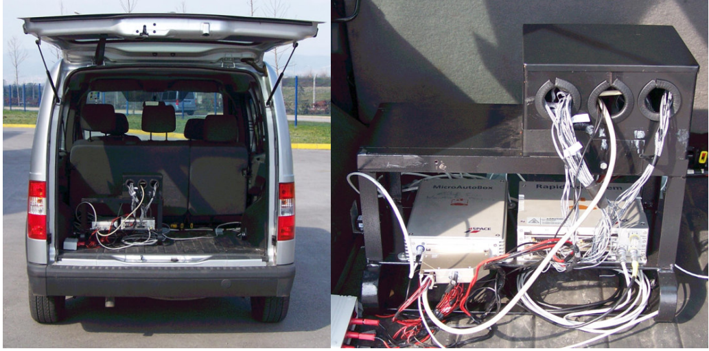
Şekil 5.14. dSpace ünitelerinin prototip taşıt üzerine yerleşimi
