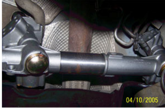
Şekil 5.9. Çift pinyonlu rak mekanizmasının taşıt üzerine montajı
