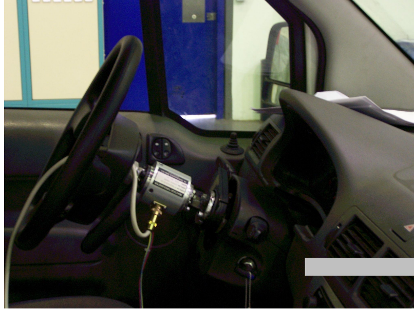
Şekil 5.12. Tork sensörünün direksiyon kolonuna montajı
