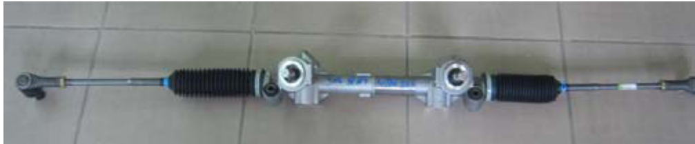
Şekil 5.8. Çift pinyonlu rak mekanizması
