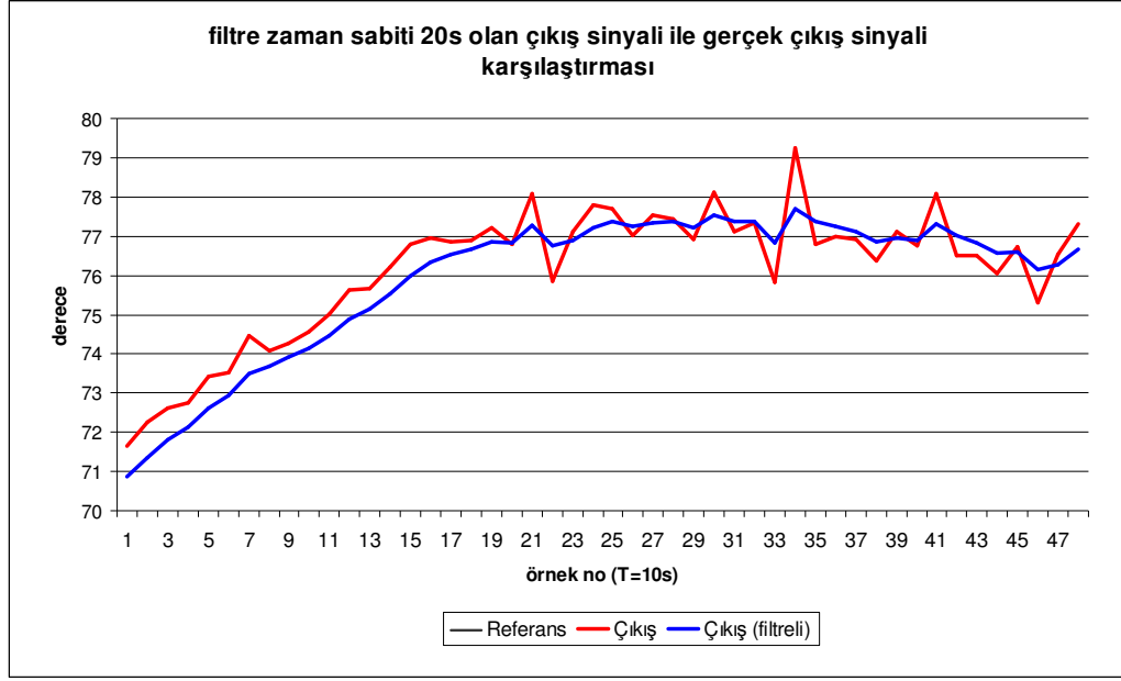
Şekil 8.24: Filtre Zaman Sabiti 20 sn. olan Filtreli Çıkış Sinyali
