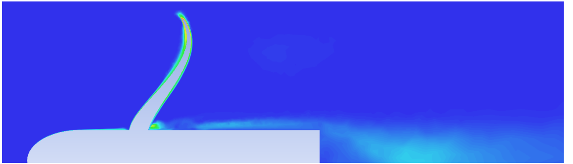
Şekil 5.14 : Pervane kesitinde oluşmuş çalkantı kinetik enerjisinin (TKE) dağılımı (maviden kırmızıya doğru artış simgeleniyor).
