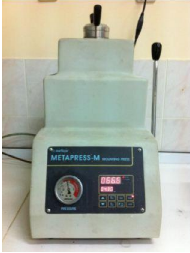
Şekil 7.5: Metapress marka gömme makinası.
