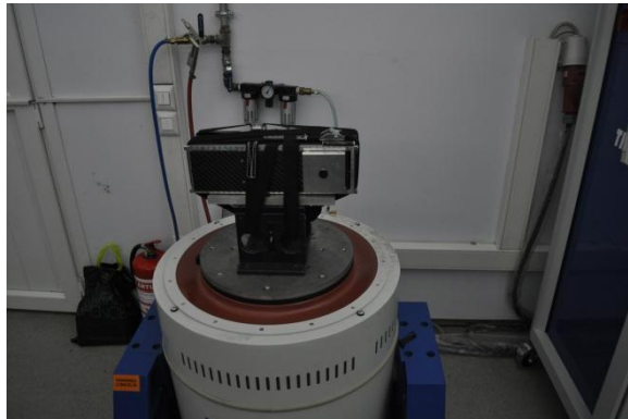
Şekil 9.5: Titreşim testleri için uydunun y ekseninde monte edilmiş test hali
