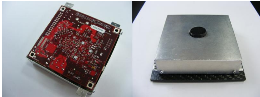
Şekil 4.3: Beagle board (solda)ve yıldız izleyic(sağda).
