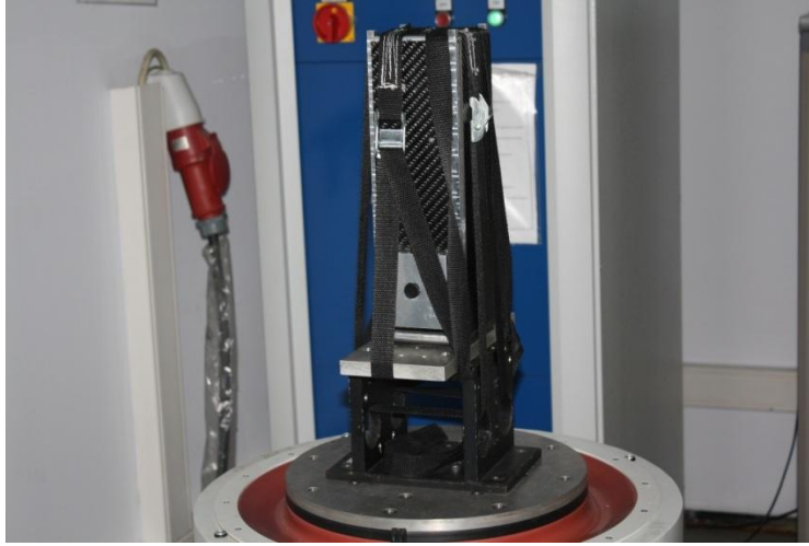
Şekil 9.16: Z eksen rezonans etüdü için yapılan bağlantı.
