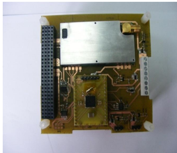
Şekil 2.4: Geliştirilen uydu uçuş bilgisayar kartı.
