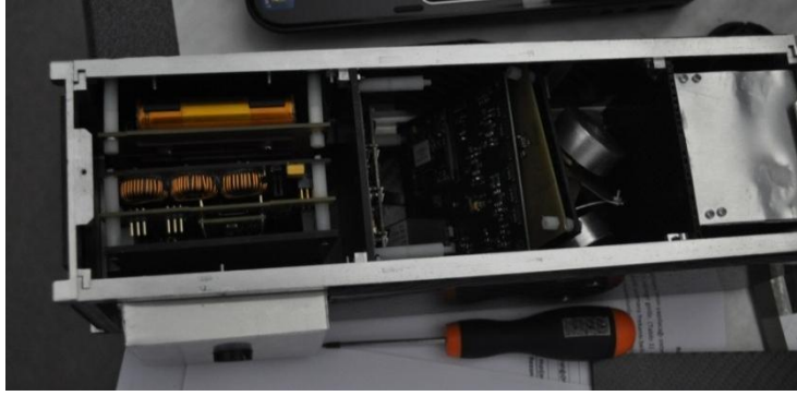
Şekil 9.8: Şok testi sonrası uydunun zarar gören kısımları.
