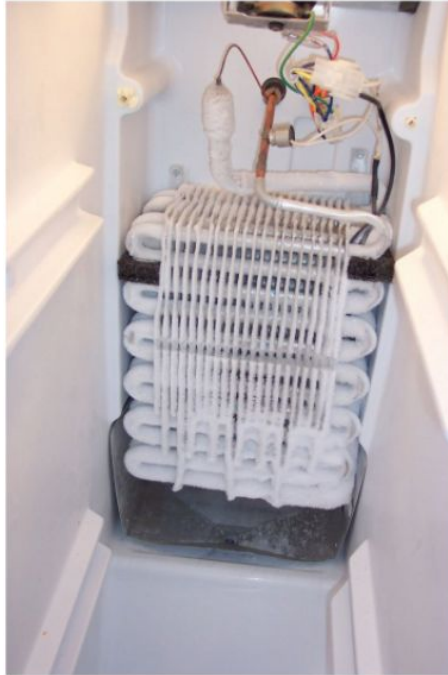
Şekil 3.2: Buzlanmış halde no frost buzdolabı evaporatörü
