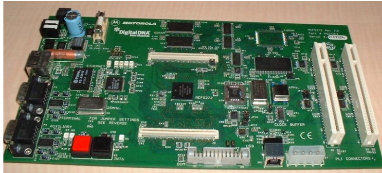
Şekil 5.1– Motorola 5272C3 Geliştirme kiti
