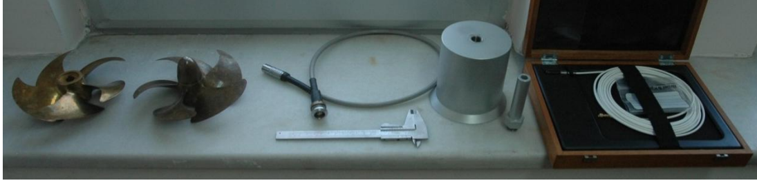
Şekil 4.5 : Biri sola diğeri sağa dönüşlü pervaneler, kavitasyon tüneli itme/moment konektörü, hidrofon için silindir parça, kutusu içinde hidrofon.
