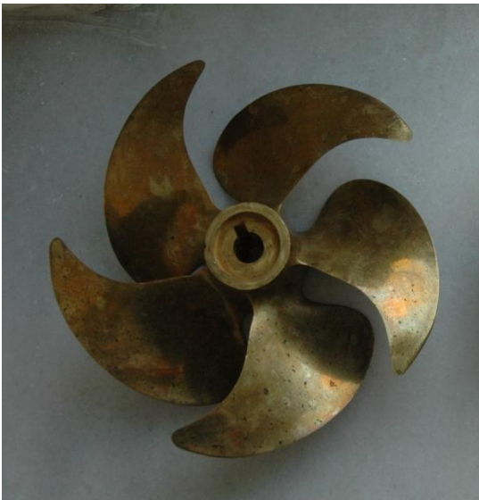
Şekil 4.8 : Akustik ölçümler sırasında kullanılan model pervaneye ait boşa ve kavitasyon tüneline takılı halde fotoğraflar.
