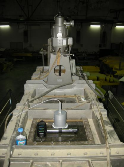
Şekil 4.6 : Hidrofonon deneyler sırasında sabitlendiği silindir kap ve kavitasyon tüneli üzerinde konumlandırılışı.
