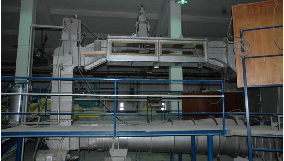
Şekil 4.1 : Ata Nutku Model Deneyi Laboratuvarı Kavitasyon Tüneli.
