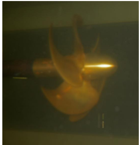
Şekil 4.8 : Akustik ölçümler sırasında kullanılan model pervaneye ait boşa ve kavitasyon tüneline takılı halde fotoğraflar.
