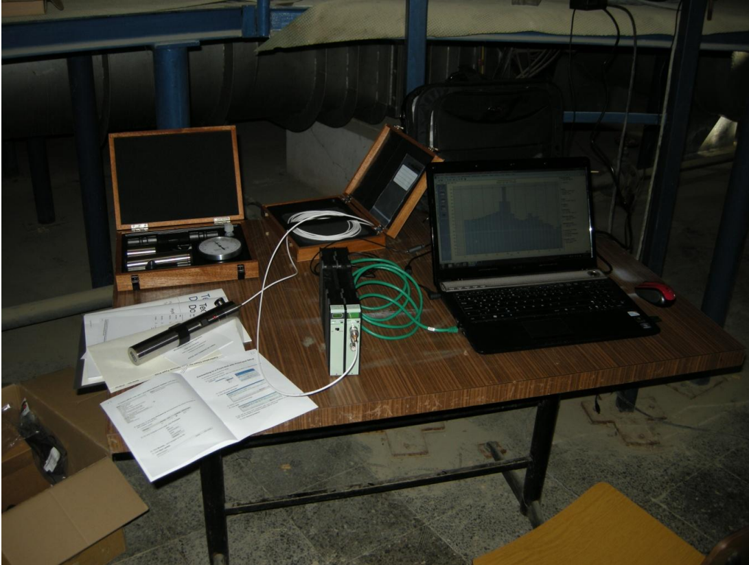
Şekil 4.2 : Bilgisayar, PULSE Analizörü, Kalibratör ve Kalibratörün içinde konumlandırılmış hidrofon.
