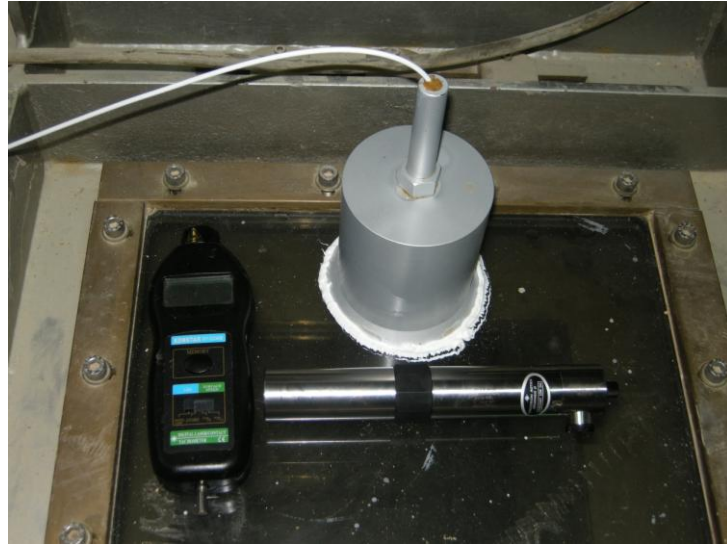
Şekil 4.6 : Hidrofonon deneyler sırasında sabitlendiği silindir kap ve kavitasyon tüneli üzerinde konumlandırılışı.
