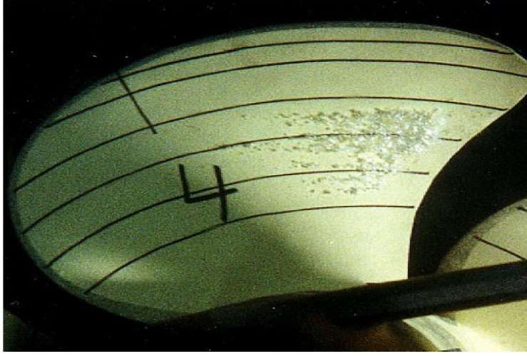
Şekil 3.25 : Pervane modeli üzerindeki kabarcık kavitasyonu (Kuiper,2010).
