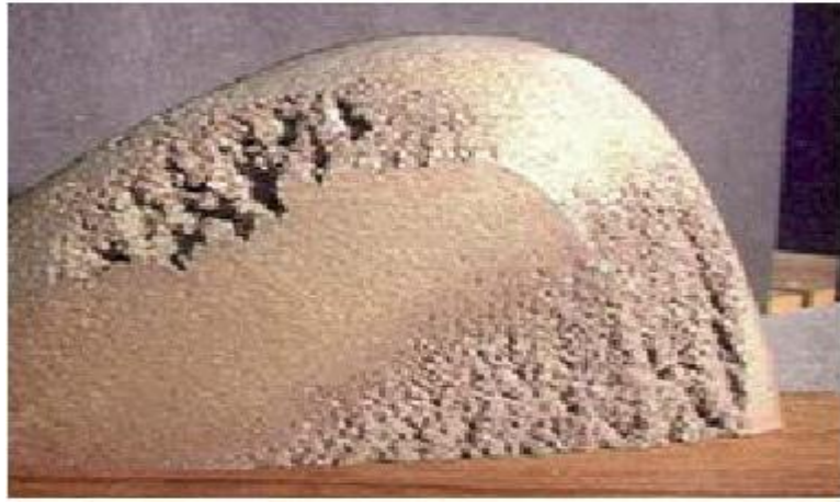
Şekil 3.29 : Pervane kanadında oluşan kavitasyon erozyonu.
