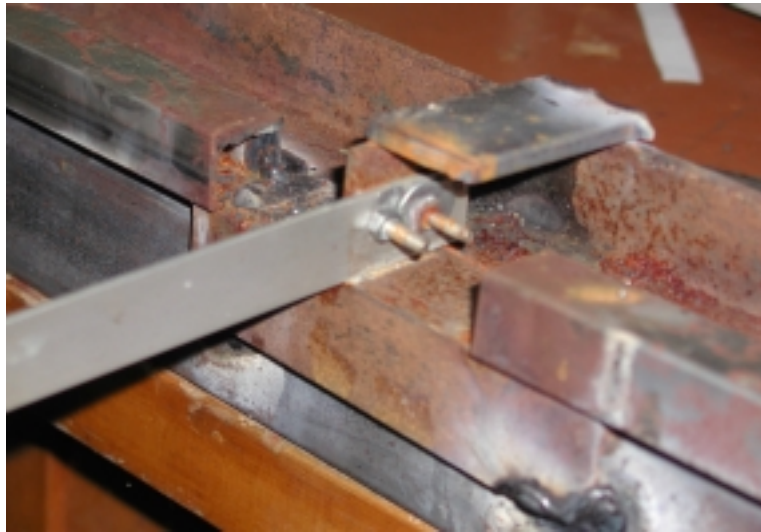
Şekil 3.24 boyuna elemanların bağlantısı.
