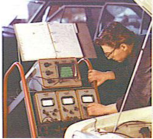
Şekil 2.7 Osiloskopun motor testinde kullanımı
