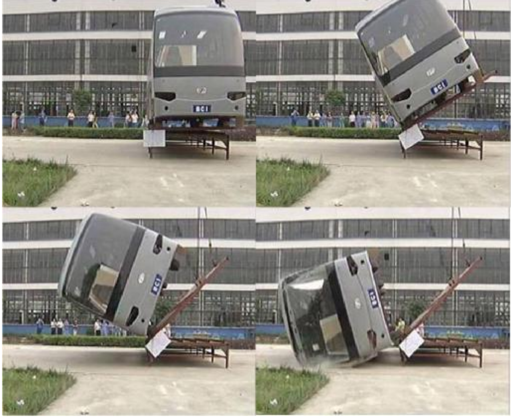
Şekil 3.7: Tam ölçekli bir taşıtın devrilme testi.
