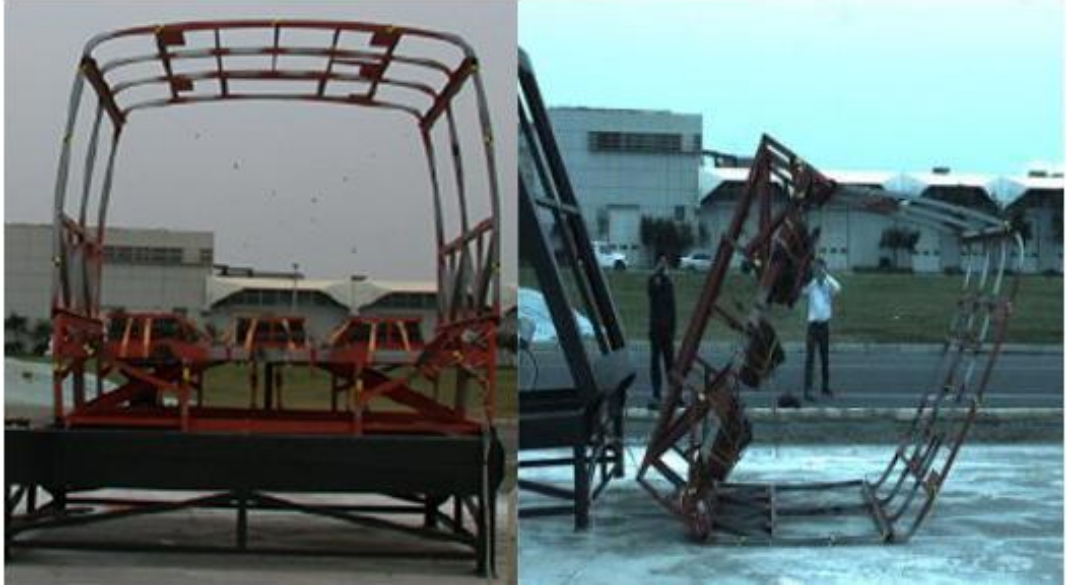
Şekil 3.9: Taşıt kesitinin devrilme testi.
