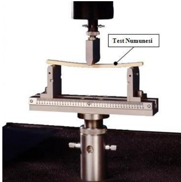
Şekil 5.15: Üç noktadan basma cihazı ve test numunesi.
