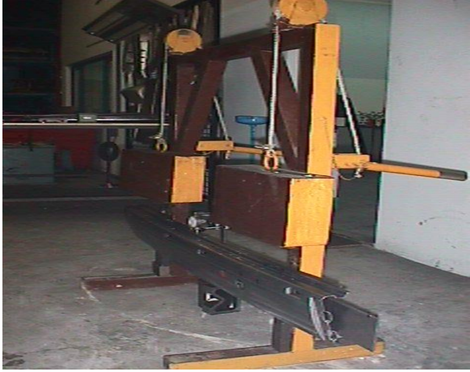
Şekil 4.13: Basamak yükleme deneyine tabi tutulan HTA tamponu
