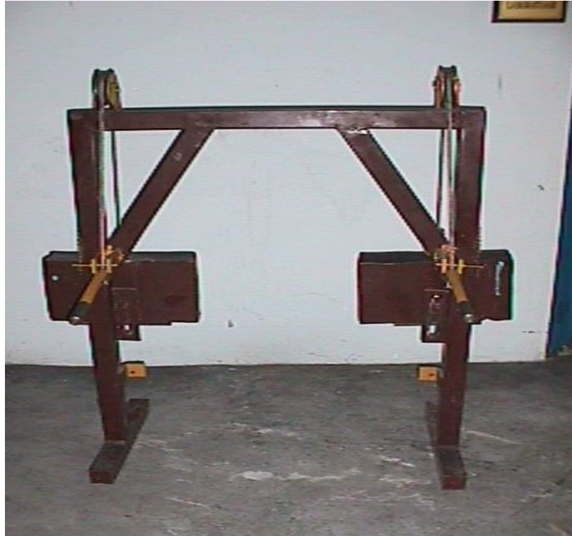
Şekil 4.12: Basamak Yükleme Deney düzeneği
