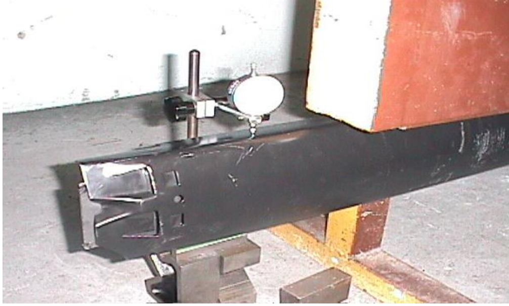
Şekil 4.21: MA tamponu ayak basma deneyi ölçüm şekli
