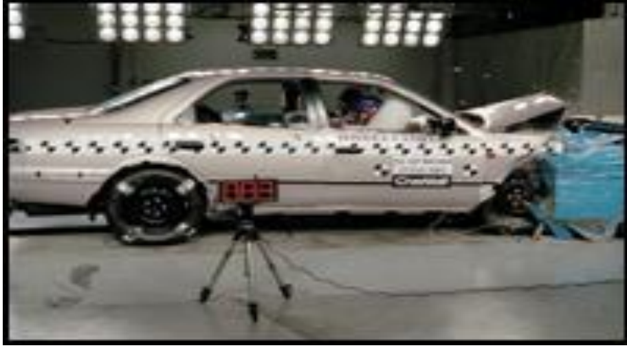
Şekil 2.3: Önden Rijit Bariyere Çarpma Test Düzenegi
