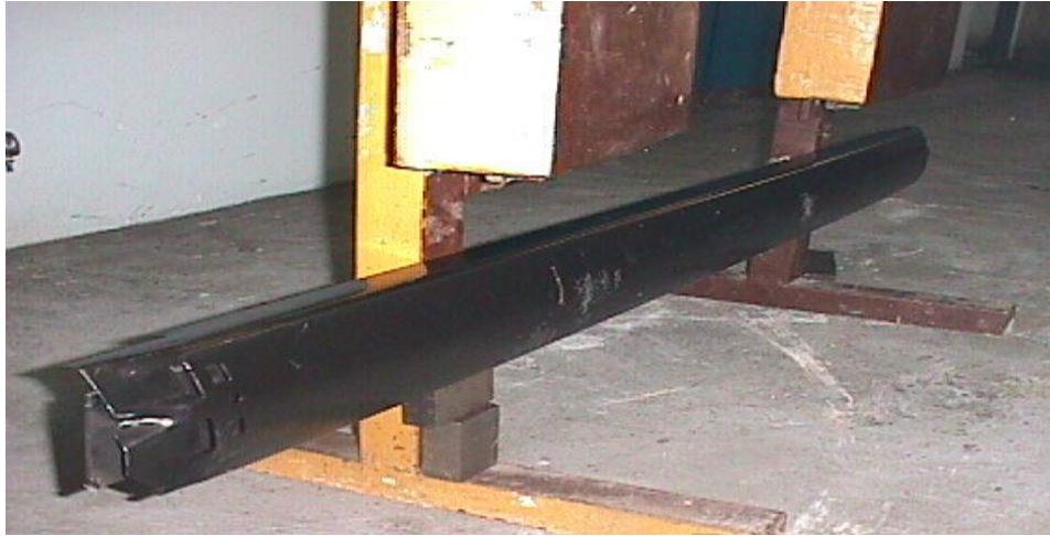
Şekil 4.20: MA tamponu Ayak basma deney düzeneęi
