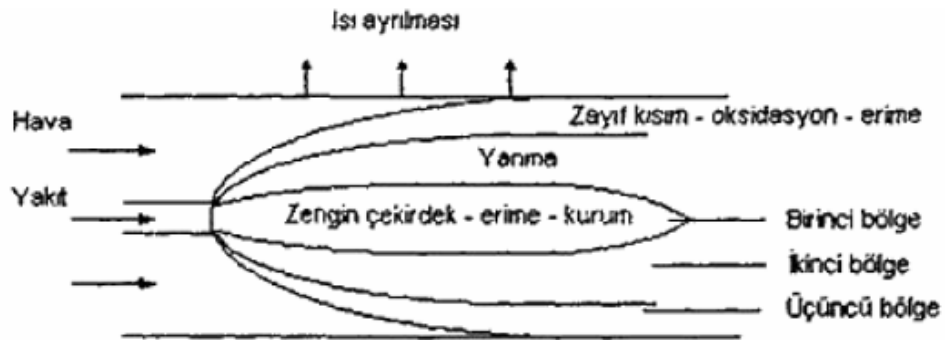
Şekil 4.12 : Türbülans Yayılımlı Alevde Kurumun Oluşumu ve Oksidasyonu
