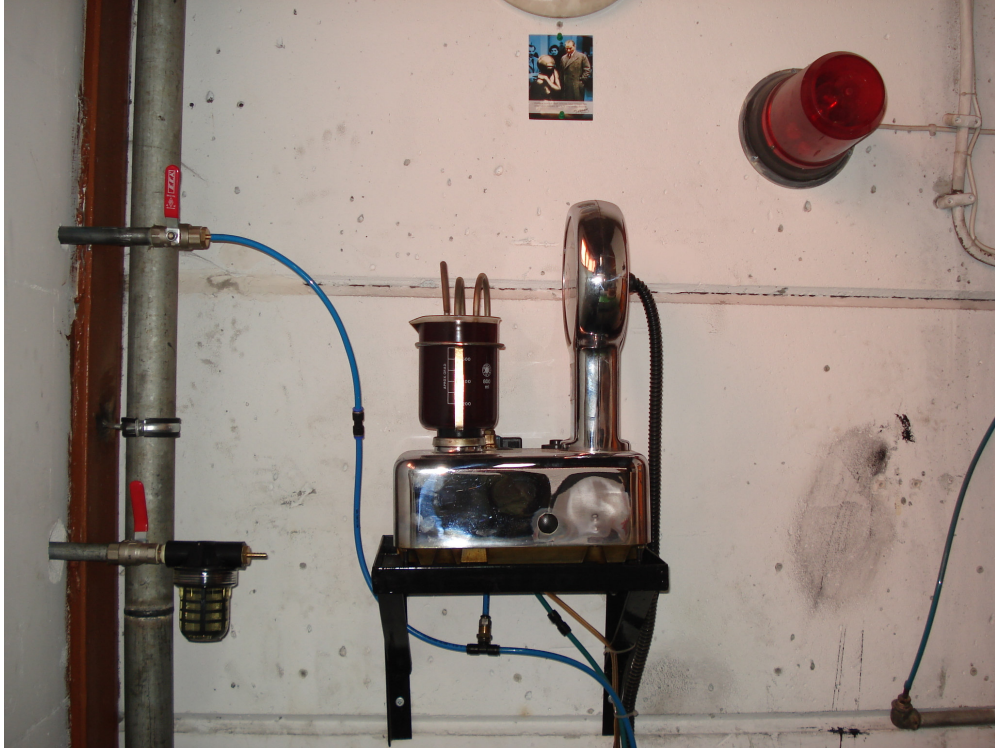
Şekil 4.6 : Deney Düzenegindeki Yakıt Tüketimini Ölçen Alet
