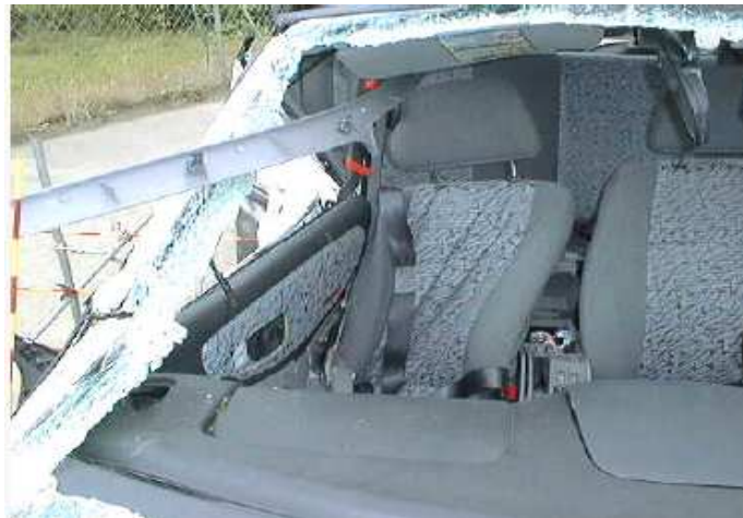
Şekil 1.8: Kapı barları kullanılmasına rağmen; büyük araçla çarpışması sonucu karşılaşılan durum,
