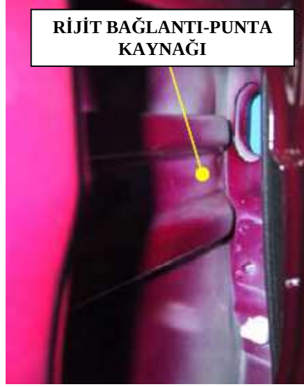
Şekil 2.5: Kapı barı bağlantıları
